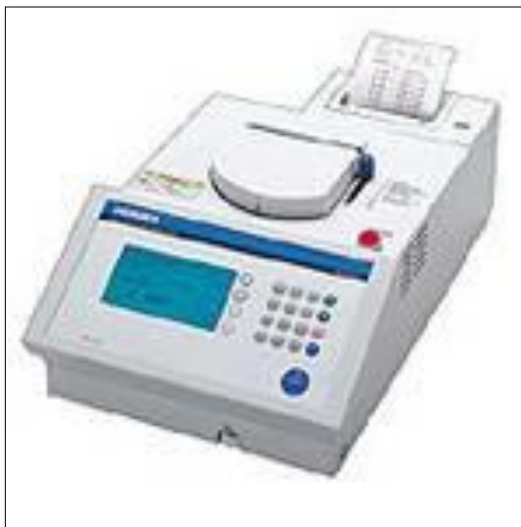
Figura 8. Equipo Horiba SLA-1800, para la determinación del contenido de azufre
