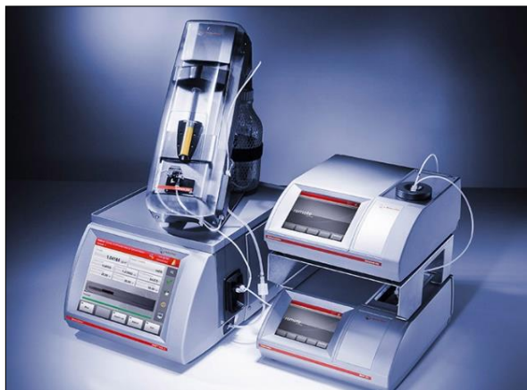
Figura 7. Densímetro Anton Parr DM-4800, para el cálculo de la gravedad API
