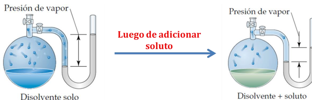
Figura 8.8. Esquema experimental para medir la presión del agua como disolvente puro y después de agregarle soluto no volátil, donde se muestra una disminución en la presión de vapor de la disolución acuosa.
