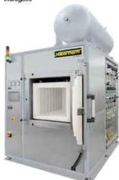
Horno de retorta VHT 100/15-KE H<sub>2</sub> con aislamiento de fibras y paquete de ampliación para el funcionamiento con hidrógeno, 1500 °C
