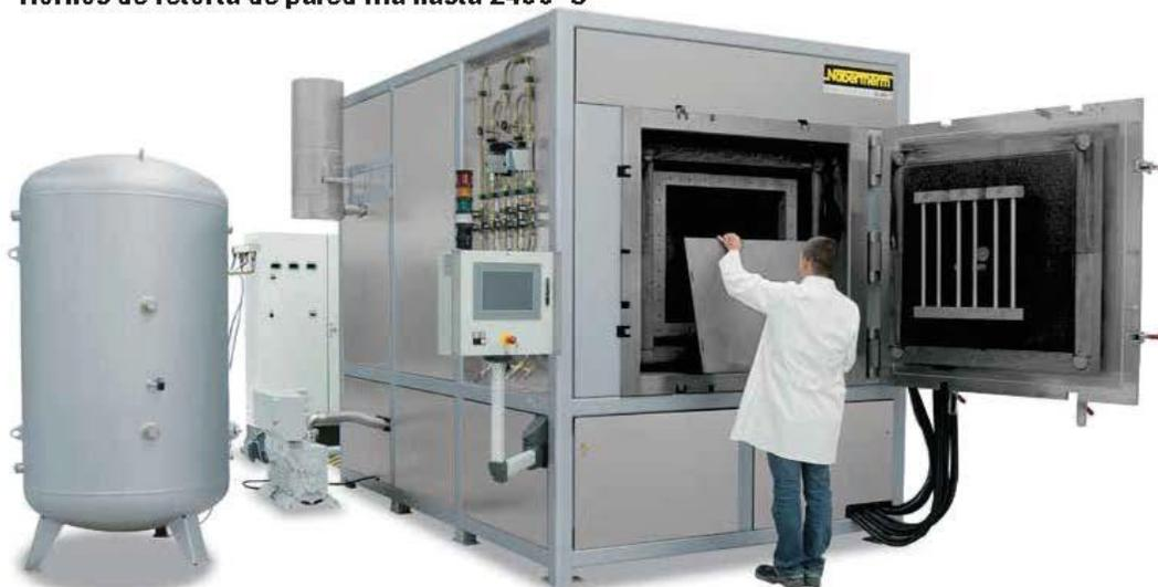
Horno de retorta VHT 500/22-GR H<sub>2</sub> con recipiente de proceso CFC y paquete de ampliación para el funcionamiento con hidrógeno
