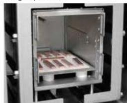
Tratamiento térmico de varillas de cobre bajo hidrógeno en horno de retorta VHT 8/16-MO
