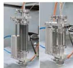
Termoelementos tipo S con dispositivo de retirada automático, para garantizar buenos resultados de medición en el rango de temperatura más bajo
