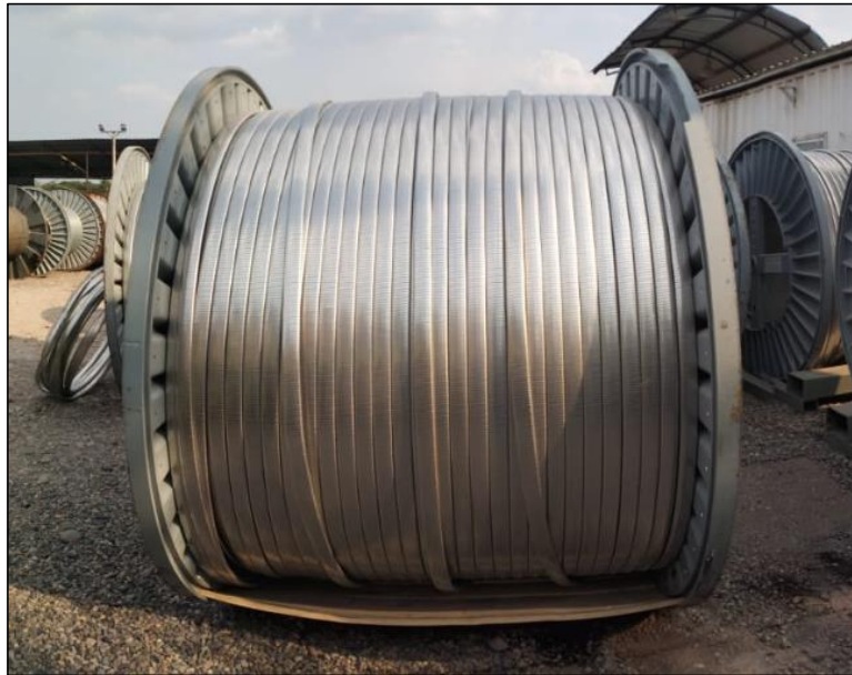
Figura 15. Cable con óptima condición mecánica en su coraza.
