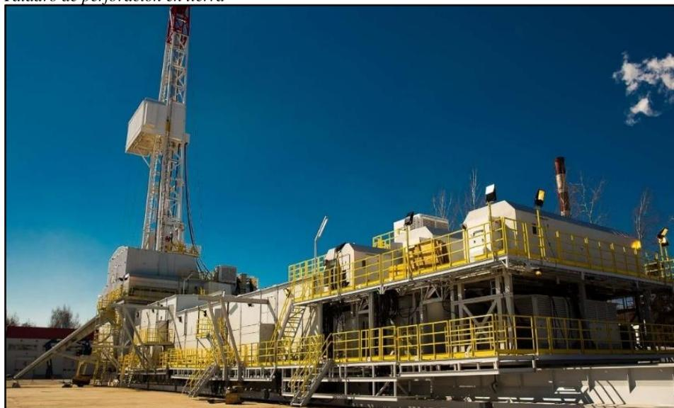
*Nota.* Taladro de perforación. De derecha a izquierda: bombas, generadores, *standpipe*, torre de perforación y mesa de perforación. Tomado de *National Oilwell Varco Inc NOV*. <https://www.nov.com/products/land-drilling-rigs>
