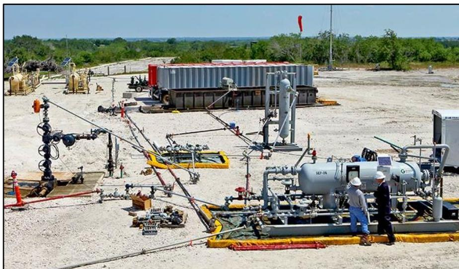
*Nota.* Ilustración general de locación en operaciones de *Well testing*. En zona superior: *Frac Tanks*. En zona central de izquierda a derecha: cabezal de pozo o *Wellhead*, *choke manifold*, trampa de arena y separador. Todo equipo empleado en fracturamiento ha sido retirado de la locación. Tomado de *Greene's Energy Group*. <https://www.greenesenergy.com/products-services/well-testing-services/well-testing/>
