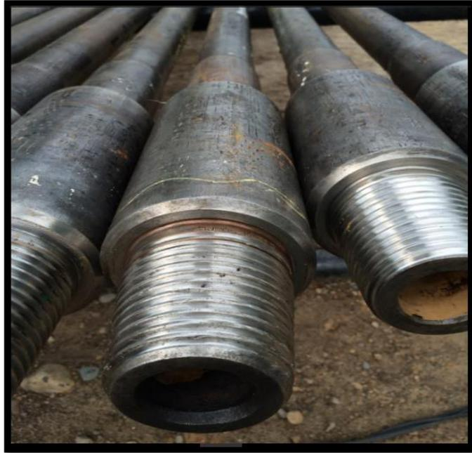
**2.1.2.5 Conexión PIN y BOX.** Es el punto de unión entre el PIN de un tubo y el BOX de otro tubo, donde como se puede ver en la **Figura 6**.
