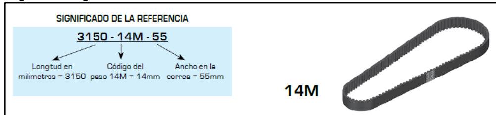
Figura 27. Significado de las referencias de las correas sincrónicas
