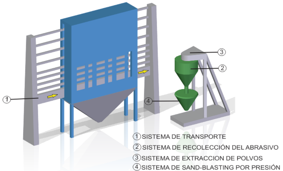
Figura 18. Sistema de Sand-Blasting por presión
