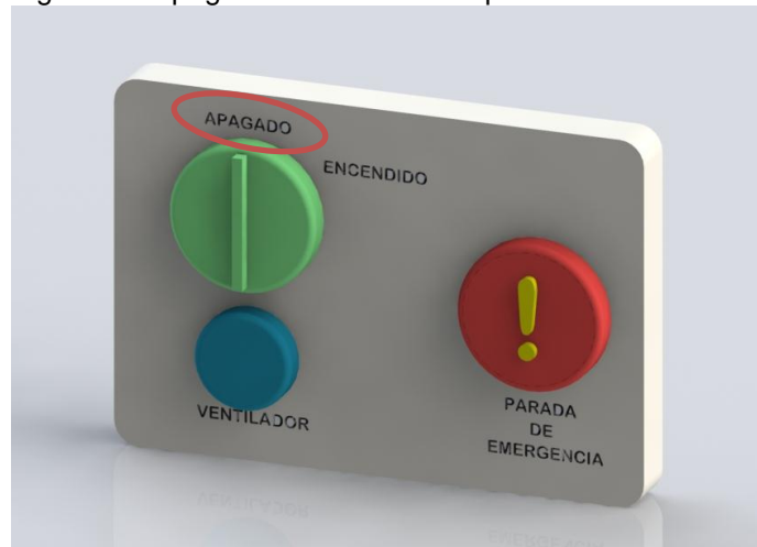
Figura 89. Apagado de la cinta transportadora
