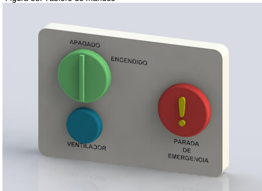
Figura 83. Tablero de mandos
