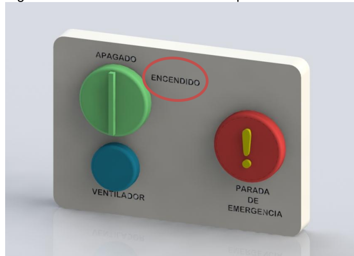
Figura 84. Encendido de la cinta transportadora
