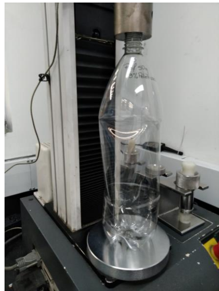
Figura 20. Botella con 3% de peletizado deformada luego de recibir carga máxima.
