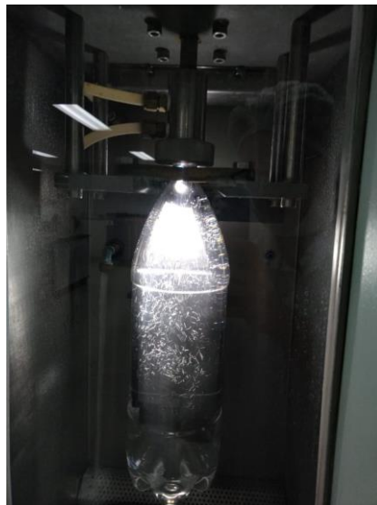
Figura 23. Botella con 3% de peletizado en proceso de llenado de agua.
