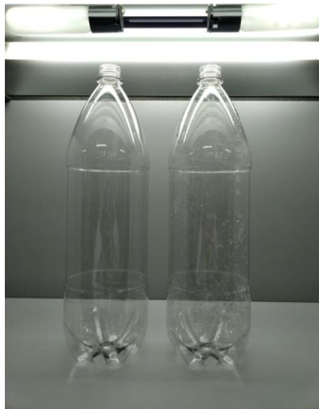
Figura 25. Botella con 3% de PET en estado amorfo antes y después de la prueba.
