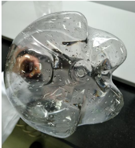
Figura 24. Base de botella con dosificación de 3% de peletizado, sin rotura ni fisura.
