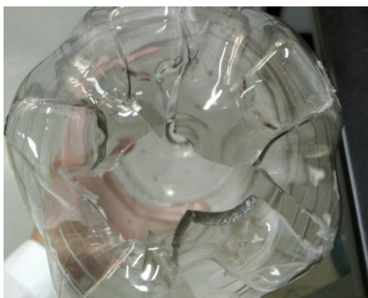
Figura 27. Botella de PET con prueba fallida.
