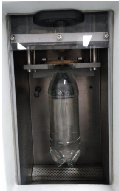
Figura 22. Inicio de prueba de resistencia a la presión interna de botella con 3% de peletizado.
