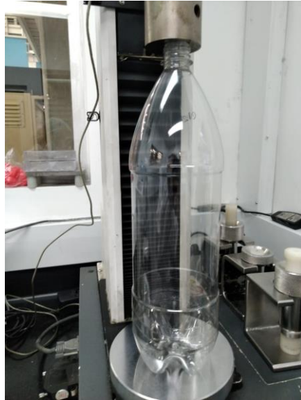
Figura 19. Botella con 3% de peletizado en posición para iniciar prueba.
