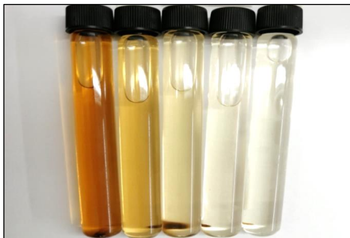
Figura 29. Lavado de BC con agua caliente
