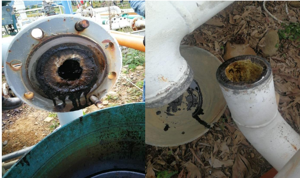
Figura 9. Reducción de la tubería e incrustaciones por depósitos en la industria en las líneas de flujo.
