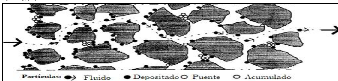
Figura 3. Esquema de las posibles deposiciones de los sólidos a través de la formación.
