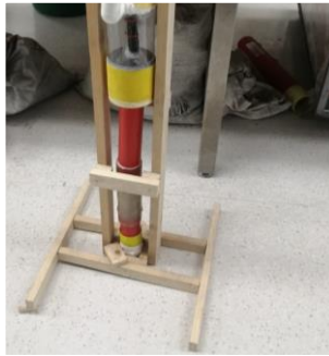
Figura 15. Base de madera reactor UASB
