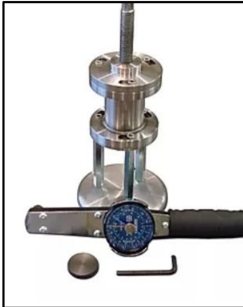
Figura 7. Equipo para prueba de Bulk Hardness.
