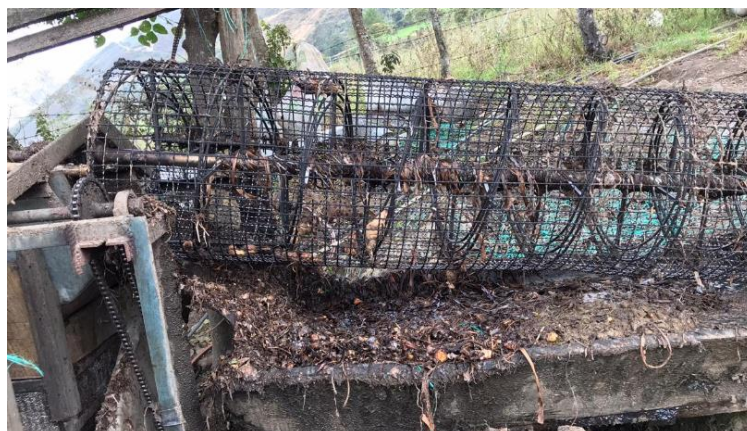
Figura 10. Lavadora Mecánica rudimentaria Fosca
