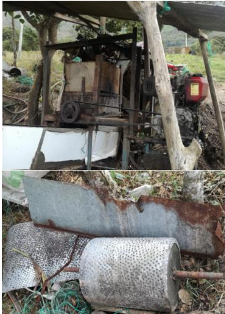
Figura 30. Ralladora Mecánica rudimentaria Fosca
