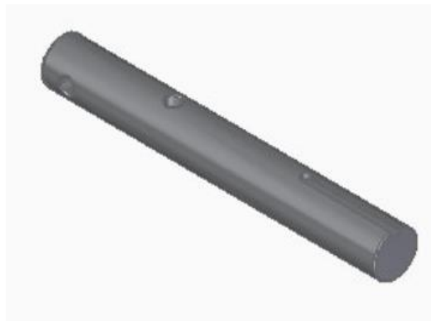
Figura 201. Eje motriz del sistema de tamizado
