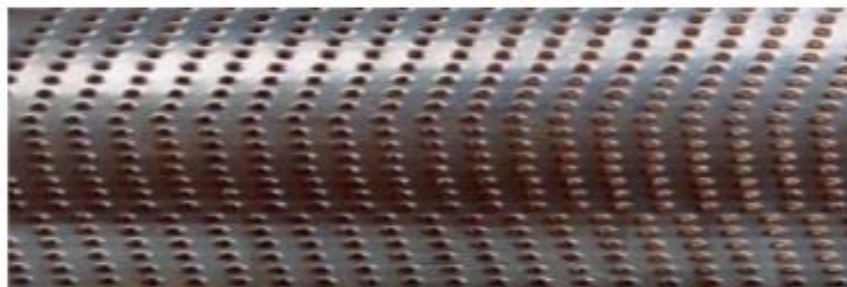
Figura 129. Troquelado óptimo de lámina ralladora
