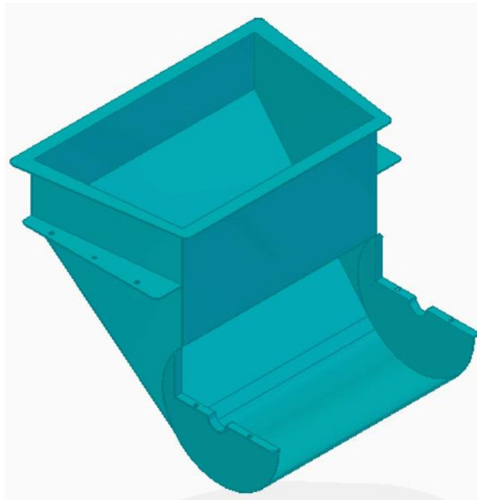
Figura 117. Tolva de alimentación sistema de rallado
