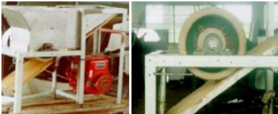
Figura 41. Ralladora de un rodillo con inclinación
