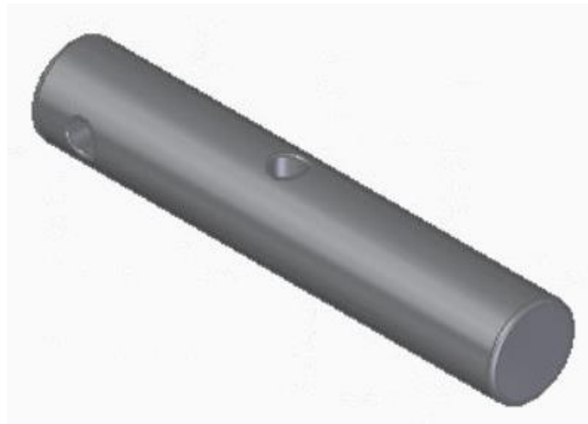
Figura 203. Eje terminal del sistema de tamizado
