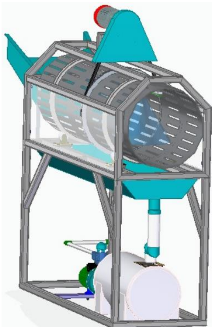
Figura 46. Sistema de lavado de la máquina para la producción de almidón húmedo de Sagú
