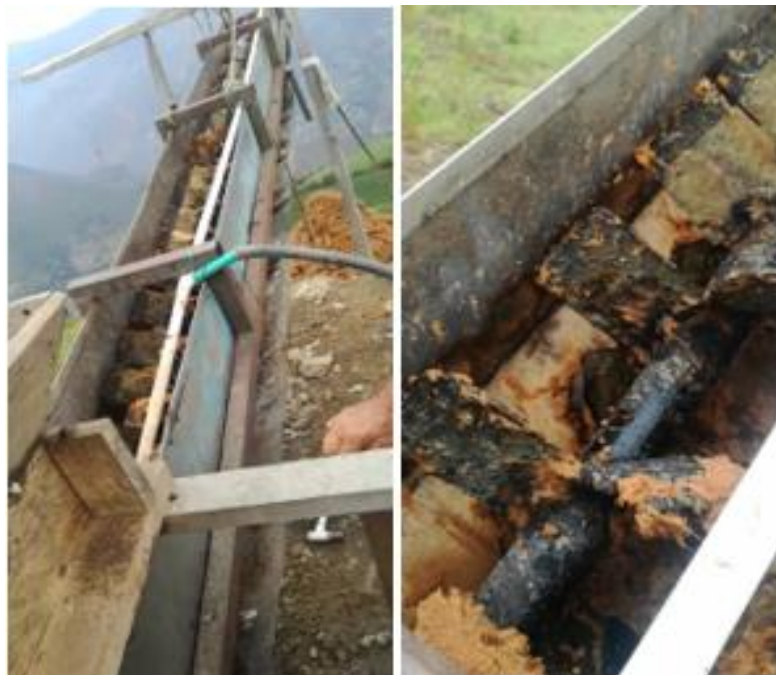
Figura 26. Tamizador horizontal de Paletas Vereda el Herrero
