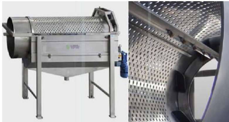
Figura 38. Lavadora rotativa por aspersion
