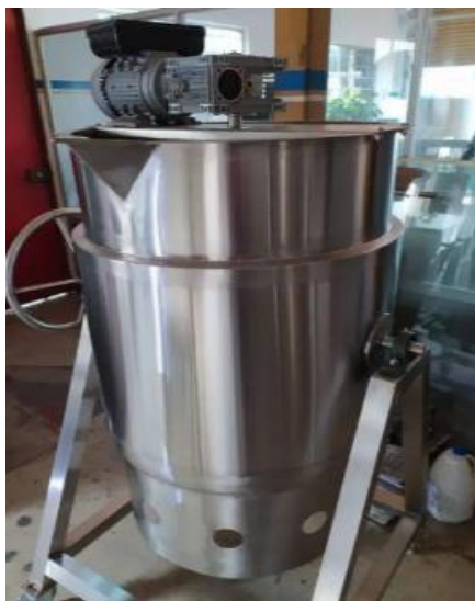
Ilustración 10. Tanque de almacenamiento de metanol.
