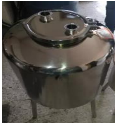
Ilustración 13. Tanque de almacenamiento de biodiésel
