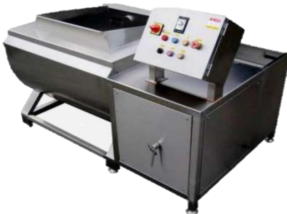
Ilustración 4. Lavadora de residuos grasos
