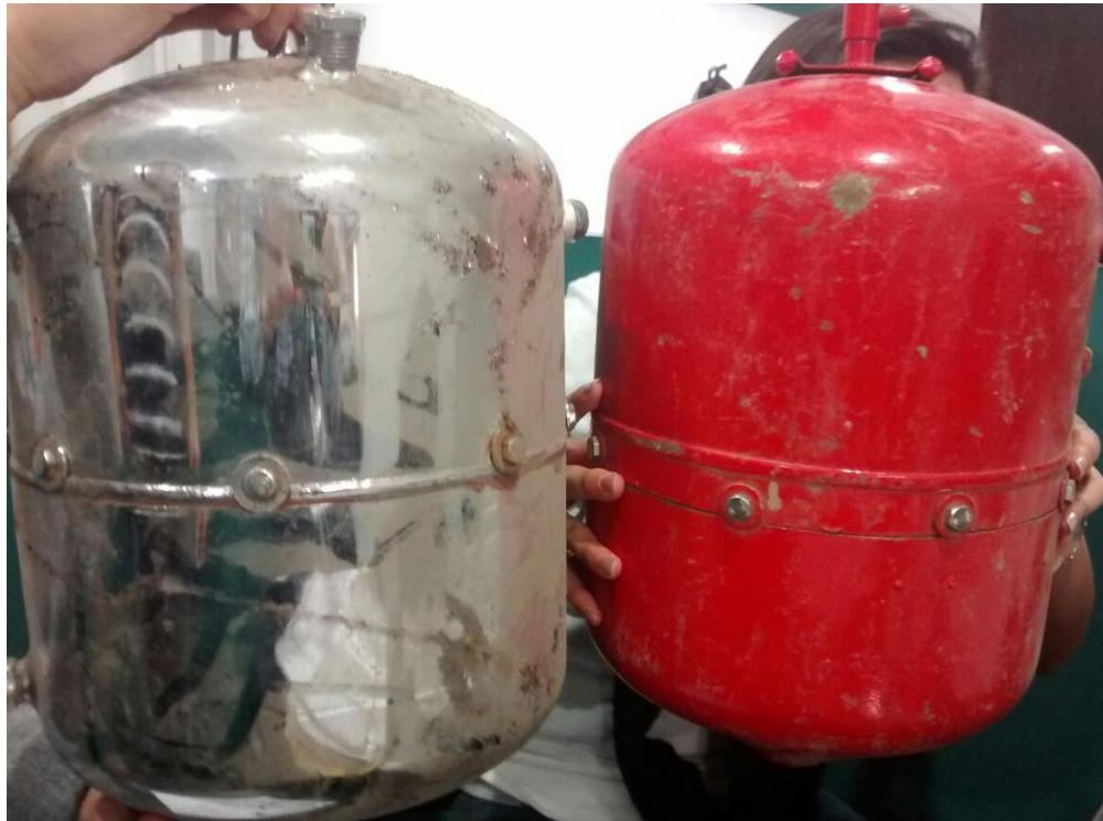
Ilustración 7. Gasómetros utilizados para almacenar el biogás.
