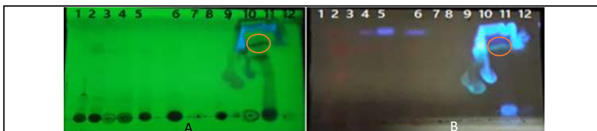
Figura 39. Placa de gel de sílice dentro de cámara de revelado con \lambda_{254} (A) y \lambda_{365} (B)
