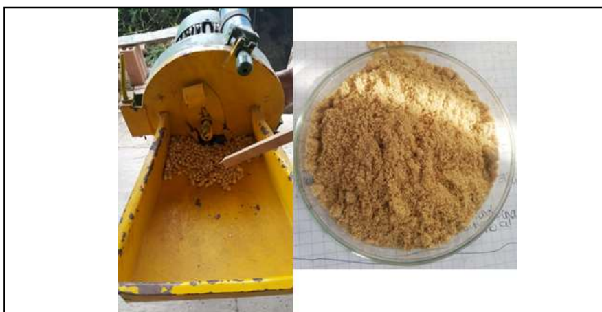
Figura 34. Molino de martillo utilizado y polvo de las semillas
