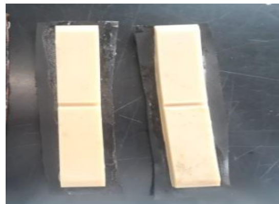
Figura 25. Probetas de caucho con 5, 10 y 15 PHR de cloropreno y parafinas cloradas para la adhesión con cauchos sintéticos.
