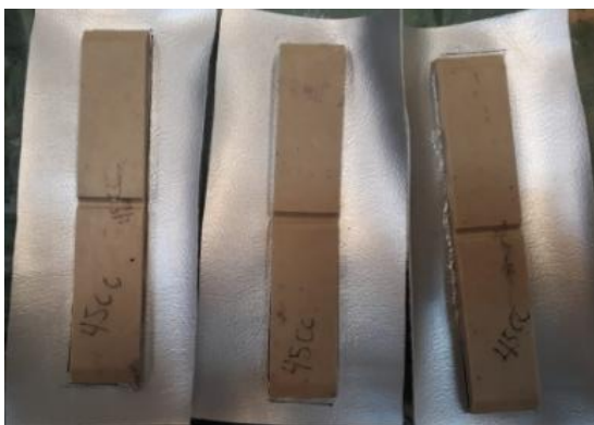
Figura 25. Probetas de caucho con 5, 10 y 15 PHR de cloropreno y parafinas cloradas para la adhesión con cauchos sintéticos.
