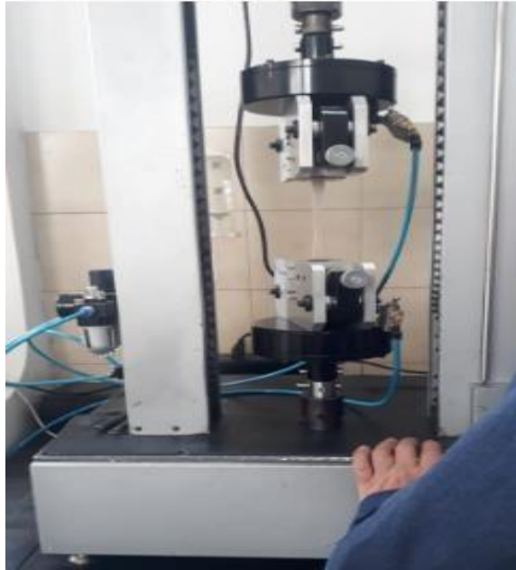
Figura 8. Tensiómetro para pruebas de tensión, elongación y resistencia al desgarre.
