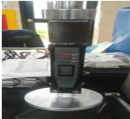
Figura 10. Equipo para medición de dureza: durómetro.
