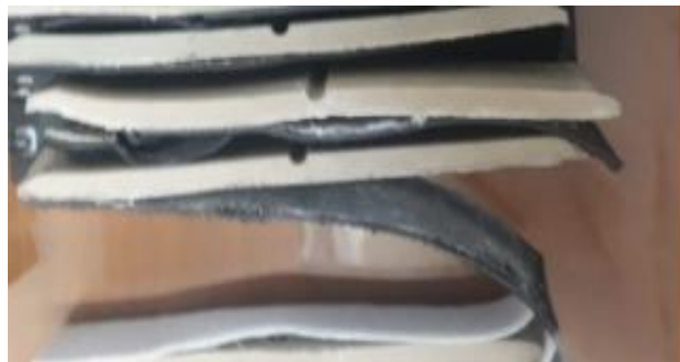
Figura 26. Probeta para la adhesión de 5, 10 y 15 PHR de cloropreno y parafinas cloradas con caucho sintético negro.
