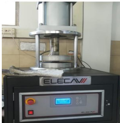
Figura 15. Equipo para medición de reometría: reómetro.
