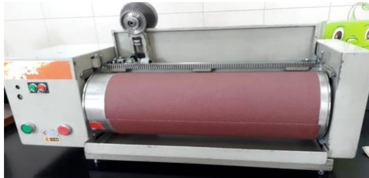
Figura 7. Equipo para la medición de abrasión: abrasímetro.
