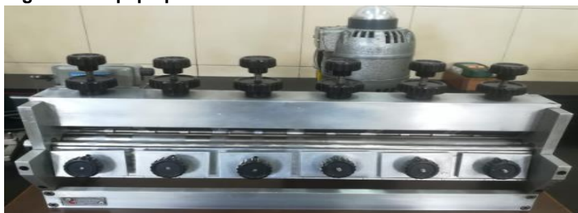
Figura 12. Equipo para medición de resistencia a la flexión: flexómetro.
