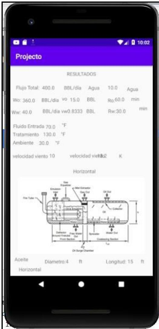
**Nota.** Esta figura muestra los resultados arrojados por la herramienta para un tratador horizontal con sus respectivos datos y dimensiones.
