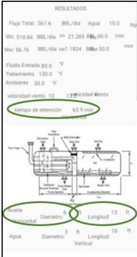
**Nota.** Esta imagen muestra los resultados del dimensionamiento para un tratador térmico horizontal según la herramienta.
