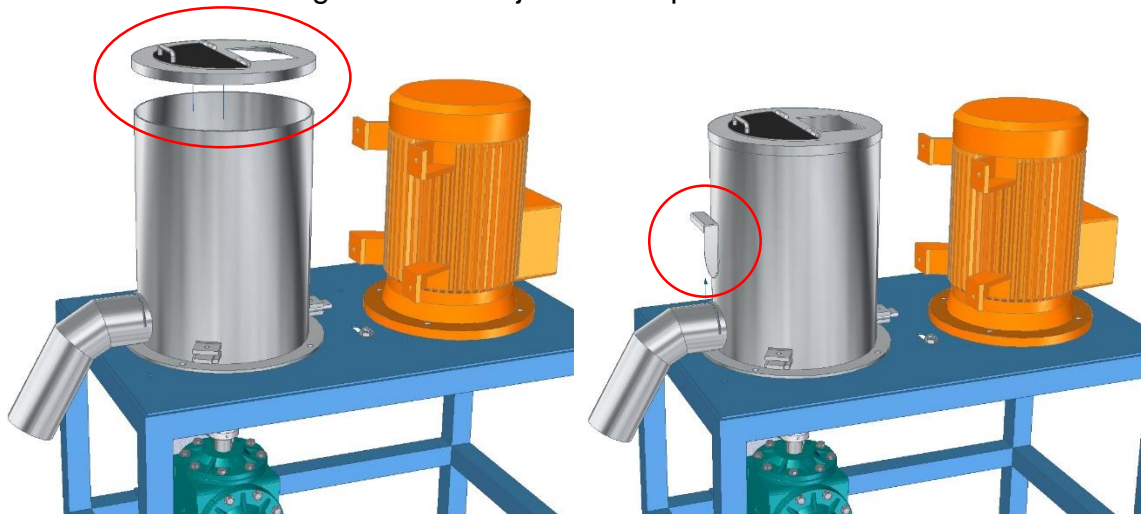
Imagen 85. Montaje de las tapas de entrada
