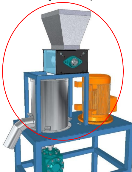
Imagen 97. Sistema desgarrador fijo en la estructura principal
