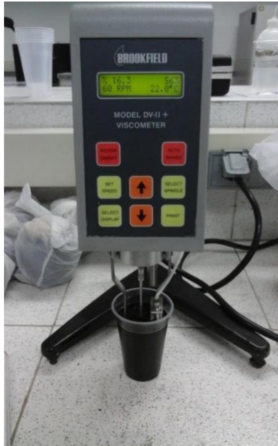
Prueba de Viscosidad aparente con viscosimetro brookfield
