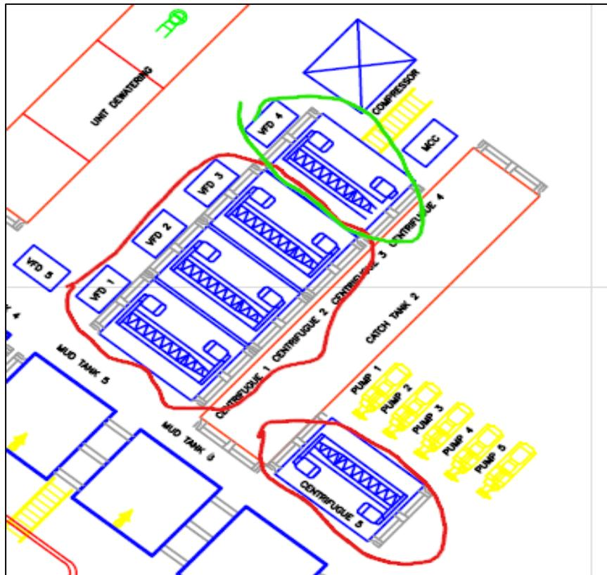
*Nota.* En esta figura se representa la distribución de equipos en la perforación del pozo A. Se encierra de color rojo las centrifugas Cen-Tex1865 y la única centrifuga Kubco, se encierra en color verde.
