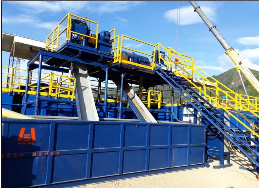
*Nota.* En la figura se resaltan las mesas diseñadas para facilitar la operación de las centrifugas Cen-Tex 1865 y Kubco.
