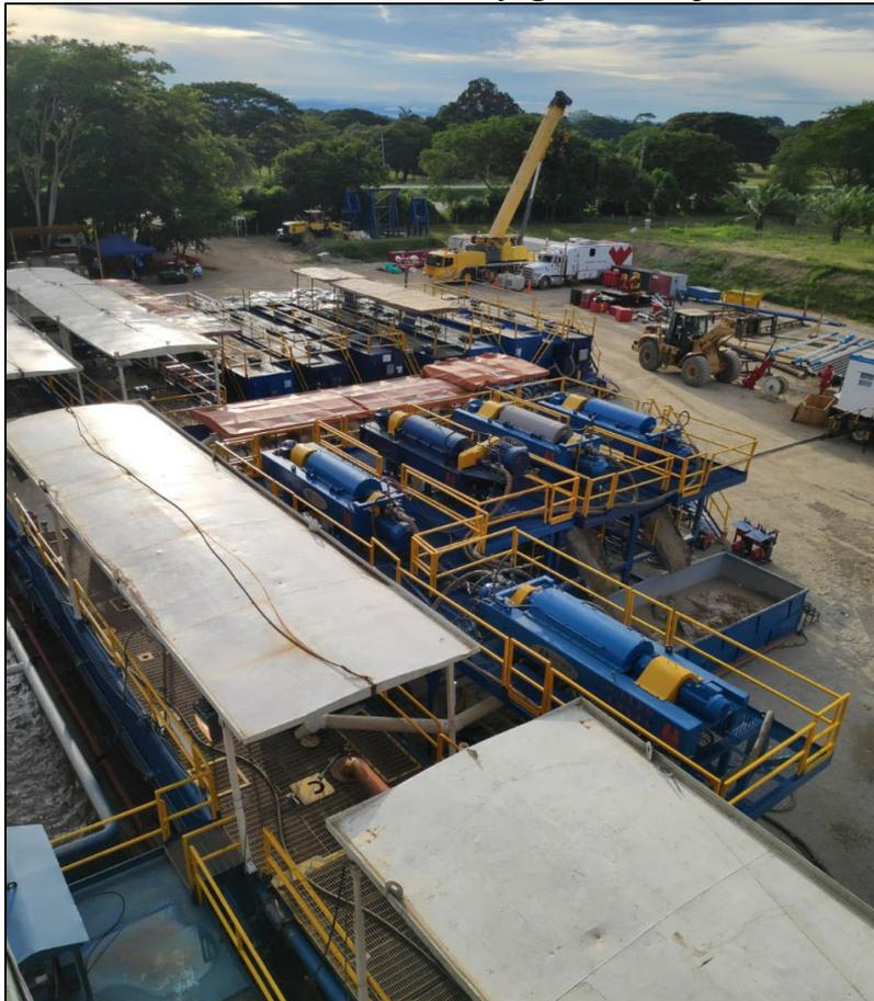
**Nota.** En esta imagen se evidencia la distribución de las centrifugas Cen-Tex 1865 y Kubco en el campo E, según como se muestra en el Layout.
