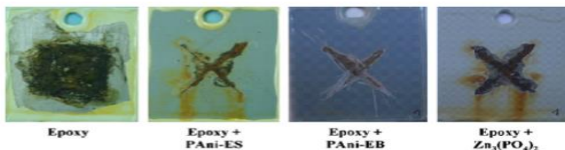
Figura 15. Panel después de 720 h en cámara salina.
