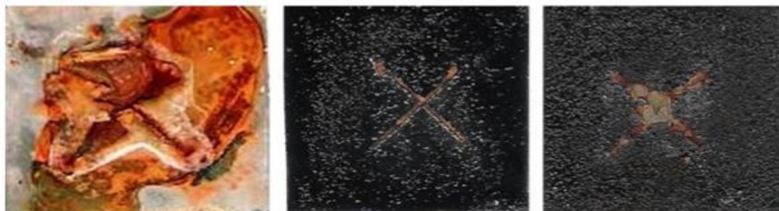
Figura 14. Imágenes de las probetas de acero después de 80 h de inmersión en 3% NaCl.
