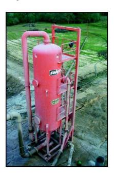
Nota. La figura representa un tipo de separador lodo / gas que existe para las operaciones de perforación. Tomado de: Long Beach City College (LBCC). Petroleum 1 Well, 2017.
