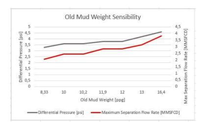
*Nota.* La figura representa la variación del diferencial de presiones y el máximo caudal de separación a diferentes densidades de lodo para el caso B
