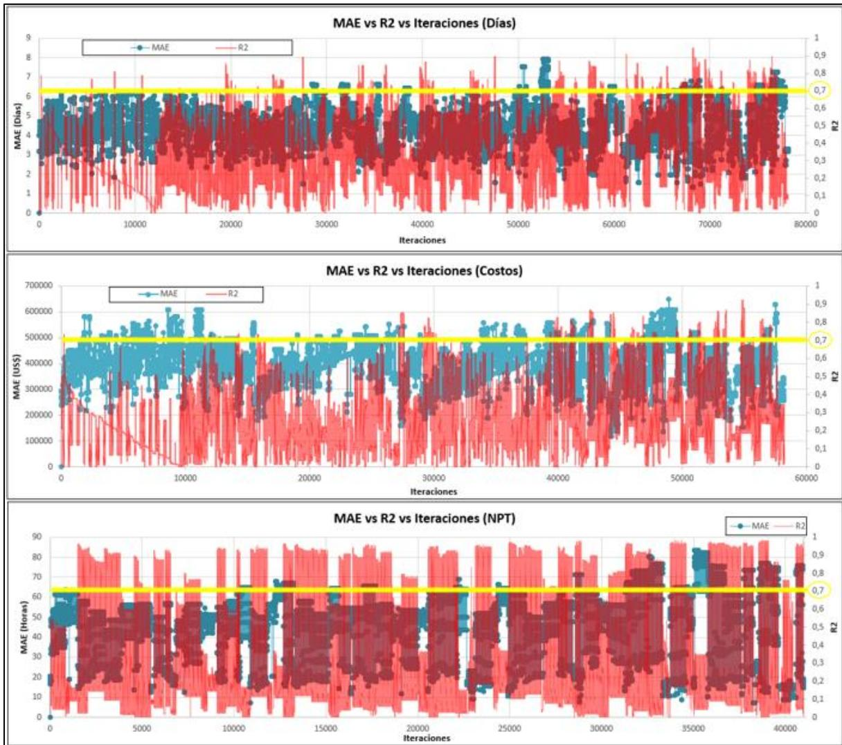
**Nota.** En la figura se puede apreciar las métricas MAE y R<sup>2</sup> para cada una de las iteraciones que realizó el *Ciclo For* para la predicción de días, costos y NPT's.
