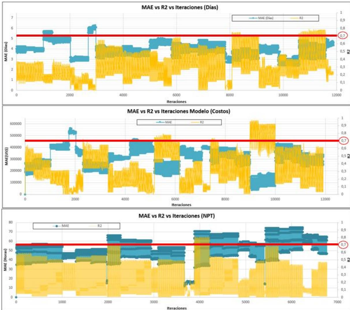
**Nota.** En la figura se puede apreciar los MAE y los R<sup>2</sup> con cada una de las iteraciones que realizo el *Bucle For* para la predicción de días, costos y NPT's.
