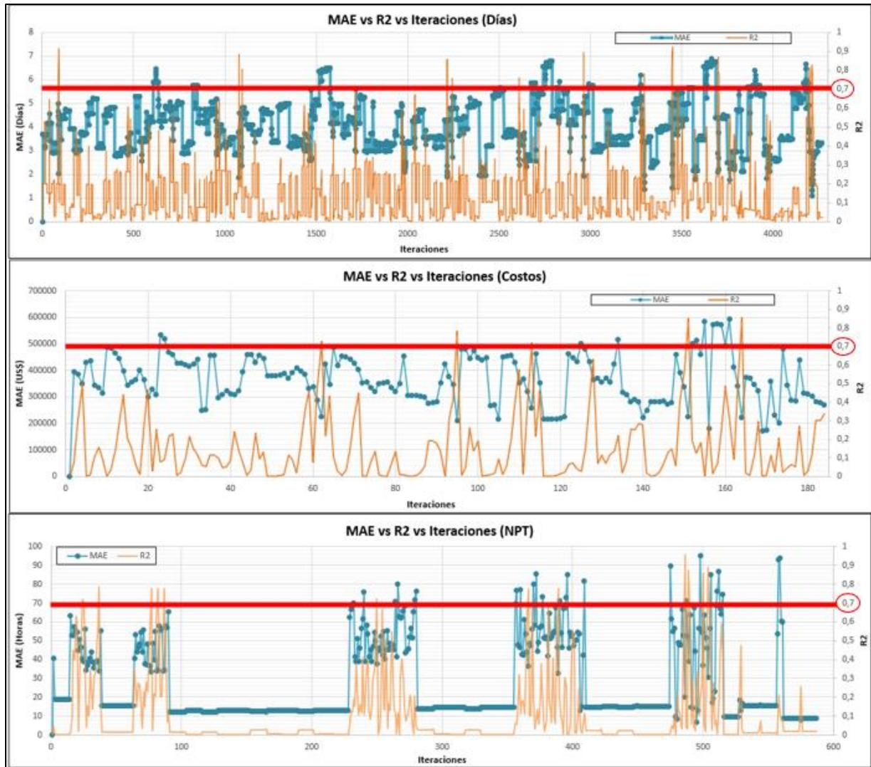
**Nota.** En la figura se puede apreciar los MAE y los R<sup>2</sup> con cada una de las iteraciones que realizo el *Bucle For* para la predicción de días, costos y NPT's
