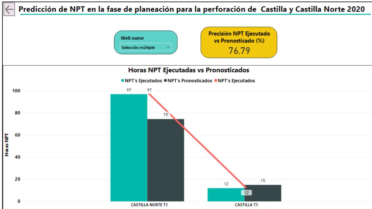
**Nota.** La figura muestra la comparación entre los costos planeados vs ejecutados vs pronosticados para los pozos con horas de NPT operacional.
