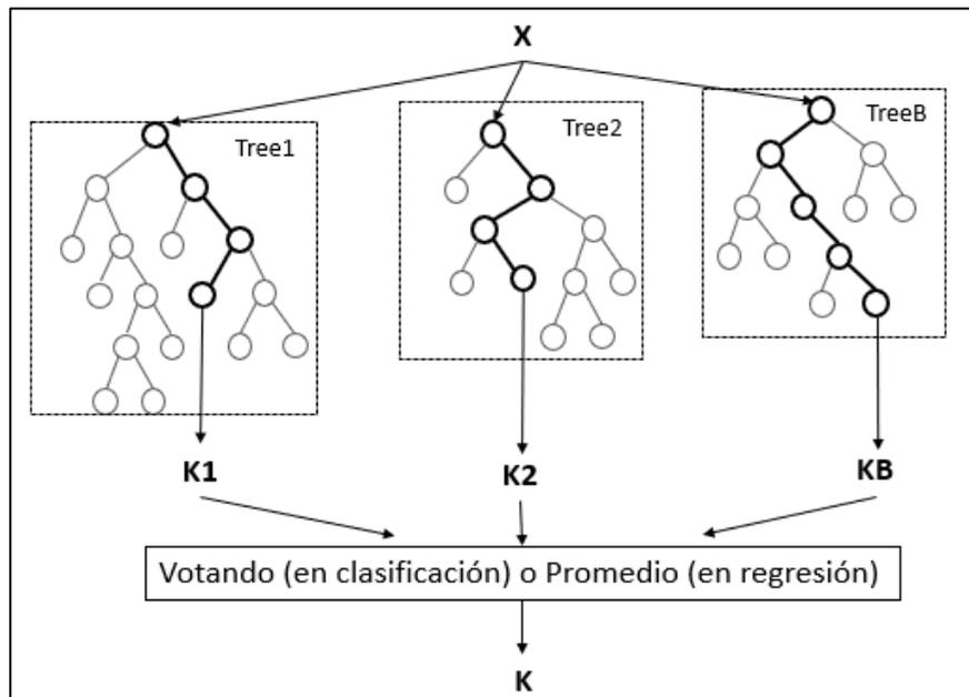
**Nota.** Funcionamiento interno del modelo bosques aleatorios durante su ejecución. Tomado de: ResearchGate [En línea]. Disponible: [https://www.researchgate.net/figure/Architecture-of-the-random-forest-model\\_fig1\\_301638643](https://www.researchgate.net/figure/Architecture-of-the-random-forest-model_fig1_301638643). [Acceso: 17 de noviembre del 2020].
