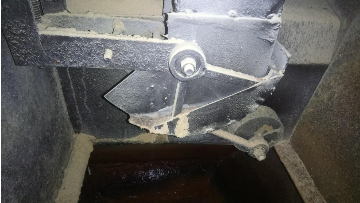
Figura 5. Mecanismo del dosificador volumétrico.
