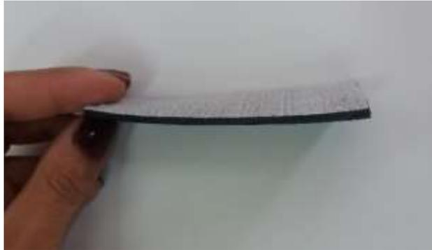
**Nota.** Muestra tomada de la bota PVC que permite apreciar la adhesión entre el PVC y el poliéster.
