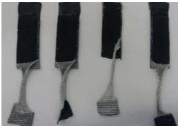
**Nota.** Resultado de las probetas después de la prueba con isobutil acetato.
