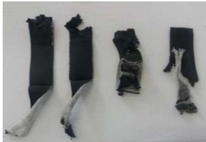
**Nota.** Resultado de las probetas después de la prueba con acetona.
