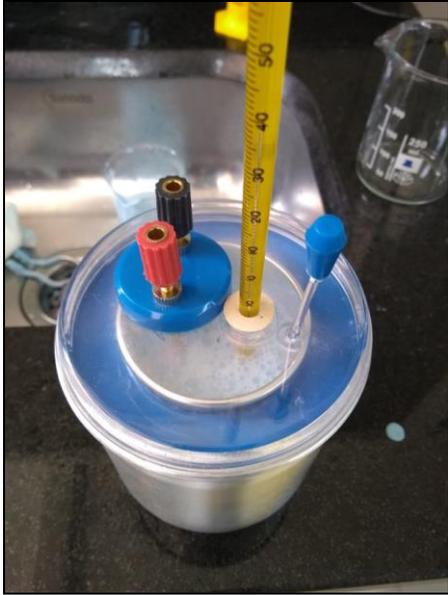
*Nota.* En la figura se muestra el momento en el que la temperatura de la mezcla (agua-detergente) llega al equilibrio. La función del calorímetro, su utilidad y sus partes se muestran en la sección **1.9 Calorímetro** del documento y en la **Figura 1** respectivamente.
