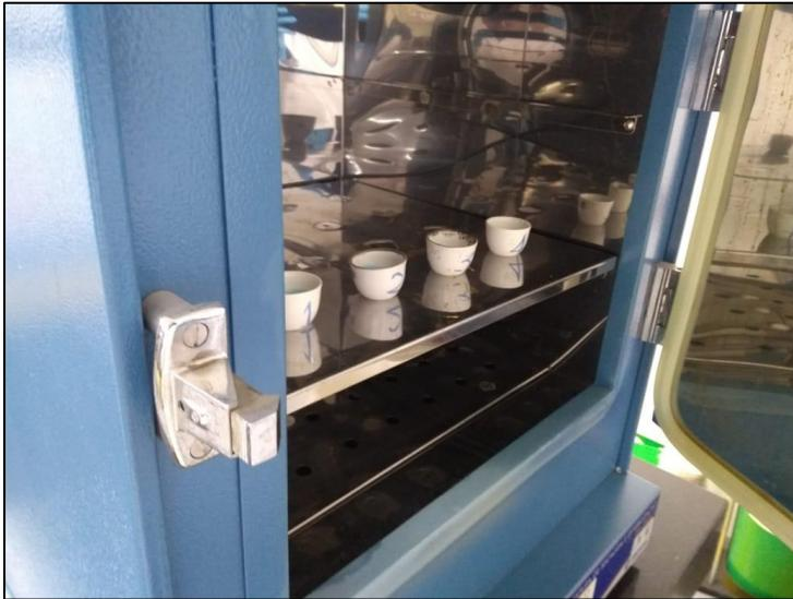
**Nota.** Esta figura muestra el horno de secado con cuatro crisoles con detergente en polvo para realizarle el calentamiento y determinar la cantidad de agua contenida.
