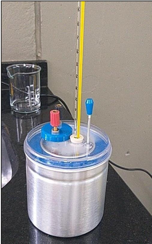
**Nota.** Calorímetro utilizado para realizar la determinación de la capacidad calorífica del detergente que entra a la torre de secado. La función del calorímetro, su utilidad y sus partes se muestran en la sección **1.9 Calorímetro** del documento y en la **Figura 1** respectivamente.
