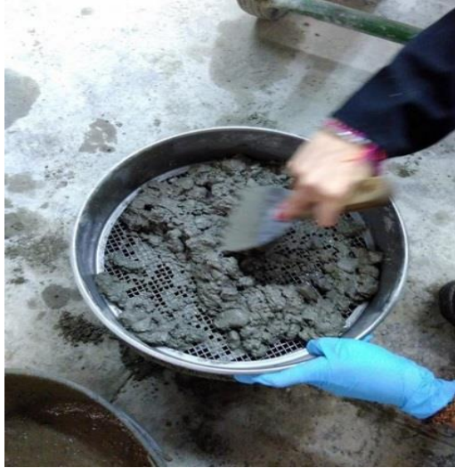
Fotografía 20. Tamizado del concreto.
