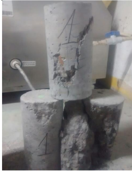
Fotografía 19. Fractura de las probetas de concreto.
