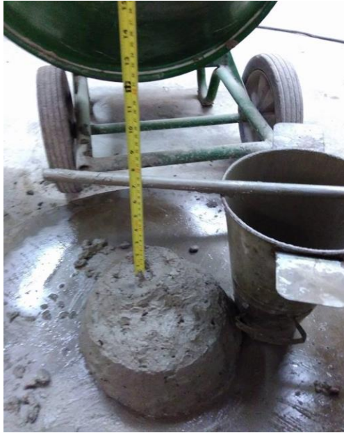
Fotografía 16. Asentamiento del concreto con aditivo.
