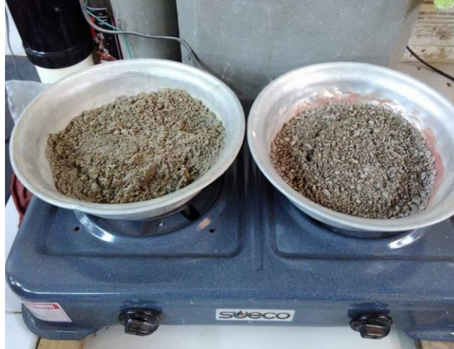
Fotografía 14. Secado de los agregados.
