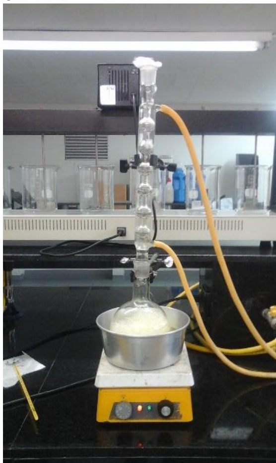
Fotografía 1. Montaje general condensación en reflujo ensayos 1 al 6
