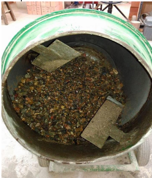
Fotografía 15. Agregados en el trompo.
