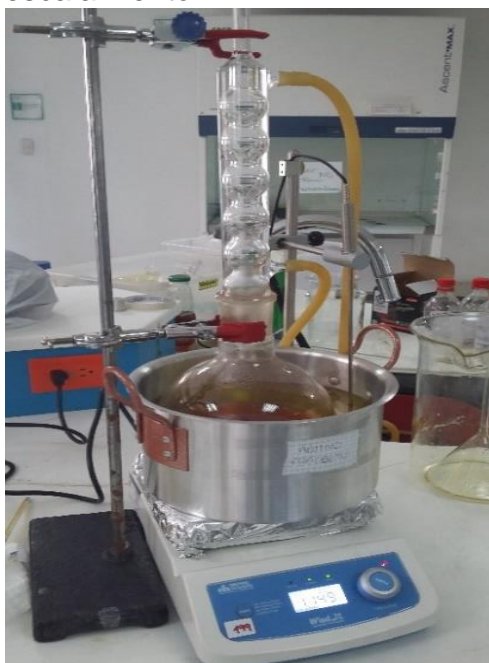
Fotografía 8. Montaje general condensación en reflujo escalamiento
