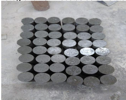
Fotografía 18. Probetas de concreto.
