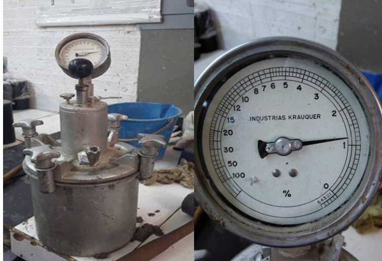
Fotografía 17. Porcentaje de aire del concreto.
