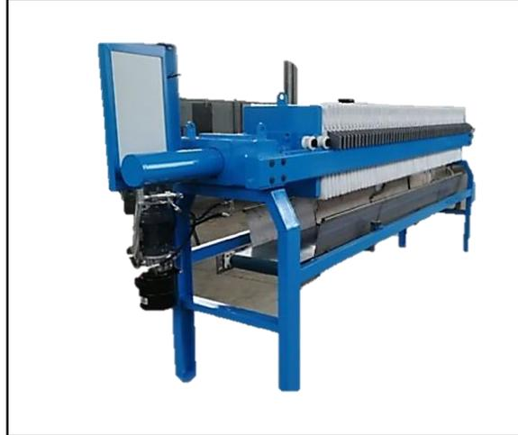
**Nota.** Se usa para los procesos de filtración para la obtención de pectina. Tomado de:
