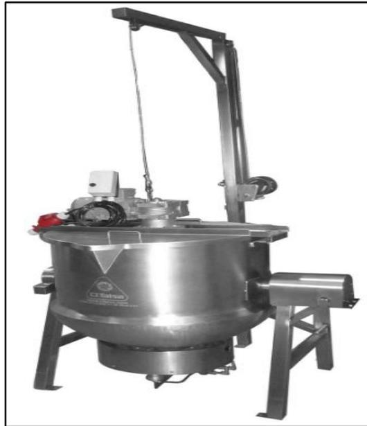
*Nota.* Se utiliza para los procesos de lavado y escaldado. Tomado de: <https://citalsa.com/marmita-volcable-a-vap-con-agitador-citalsa-mv100>
