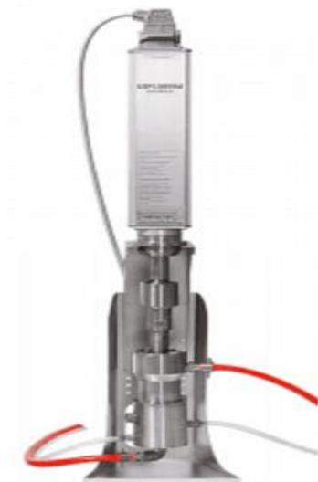
**Nota.** Equipo para la extracción ultrasónica empleada después del proceso común de la infusión. Tomado de: HIELSCHER. “Extracción catalítica asistida por ultrasonidos”, Tecnología de ultrasonido, (s.f.). [En línea]. Disponible en: <https://www.hielscher.com/es/ultrasonically-assisted-catalytic-extraction.htm>
