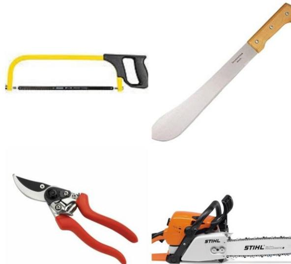
*Nota.* Equipos empleados en la aplicación para el control agrícola, donde la herramienta de la parte superior izquierda corresponde a la segueta, superior derecha es el machete, inferior izquierda son las tijeras de poda e inferior derecha es la motosierra. Tomado de: Fundación MCCH, “Podas en el cacao”, (s.f.). [En línea]. Disponible en: [http://cadenacacaoca.info/CDOC-Deployment/documentos/Podas\\_en\\_cacao.pdf](http://cadenacacaoca.info/CDOC-Deployment/documentos/Podas_en_cacao.pdf)
