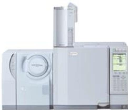
**Nota.** Equipo empleado para la cromatografía en gases después de realizar el proceso de extracción por maceración con solvente. Tomado de: Select Science, “GCMS-QP2010 Plus by Shimadzu Europa GmbH”, Cromatografía productos, (s.f.). [En línea]. Disponible en: <https://www.selectscience.net/products/gcms-qp2010-plus/?prodID=81106>
