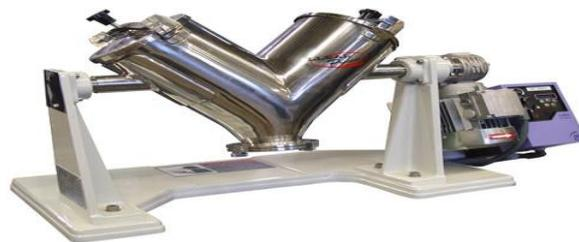
**Nota.** Mezclador de tipo V usado para la homogeneización y mezcla de agua con el material vegetal en el proceso de purín. Tomado de: LLEAL S.A., “Mezclador de sólidos en V de laboratorio”, Producto feria virtual interempresas química, (s.f.). [En línea]. Disponible en: <https://www.interempresas.net/Quimica/FeriaVirtual/Producto-Mezclador-de-solidos-en-V-de-laboratorio-BL-8-BL16-66675.html>
