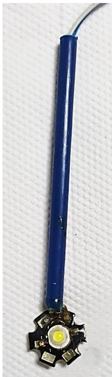
Imagen 3 LED de alta potencia de 1W y longitud de 395-405 nm.
