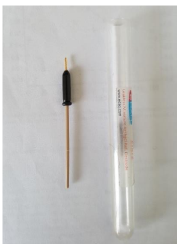
Imagen 6 Electrodo de referencia E-DAQ plata /cloruro de plata Ag/AgCl.
