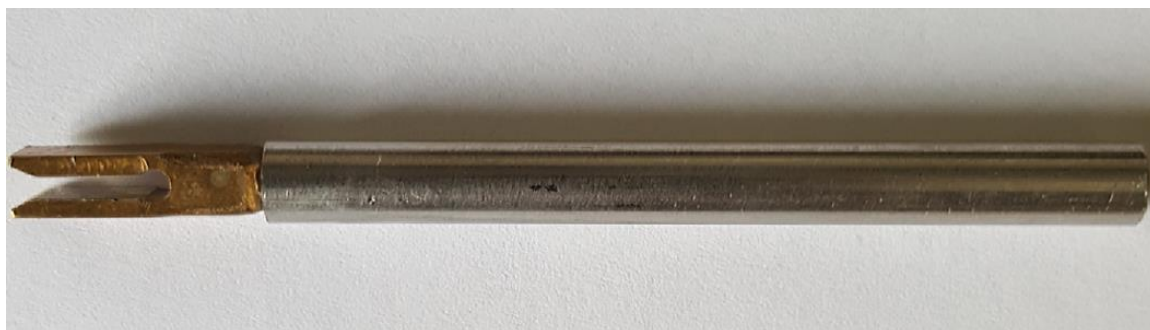
Imagen 4 Porta electrodo en acero inoxidable para las láminas de vidrio ITO.
