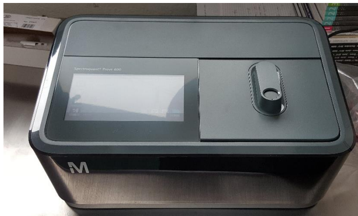
Imagen 32 Espectrofotómetro de marca Merck Spectroquant Prove 600.
