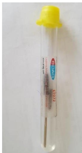
Imagen 7 Electrodo de referencia E-DAQ de platino Pt.
