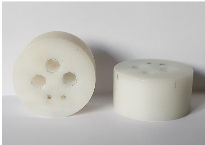
Imagen 2 Tapa para reactor en nylon con configuración para electrodos y degradación.
