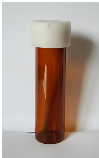
Imagen 1 Reactor con capacidad de 50 mL En Vidrio Ámbar.
