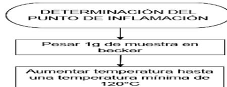
**Nota.** La figura representa el procedimiento para la determinación del punto de inflamación en el biodiésel.
