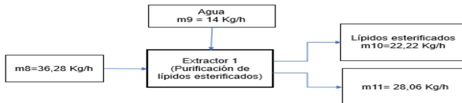
**Nota.** Esta figura muestra el balance de masa del extractor 1 donde ocurre la purificación de los lípidos esterificados para la simulación a condiciones de  $P > 10$  bar.
