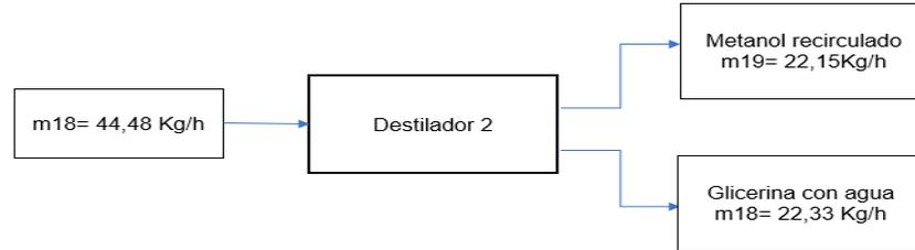
**Nota.** Esta figura muestra el balance de masa del destilador 2 de la purificación del biodiésel, para la simulación a condiciones de  $P < 10$  bar
