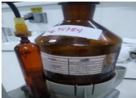
**Nota.** La figura representa la determinación del índice de acidez del biodiésel, realizado en el laboratorio de la empresa C.I. SIGRA S.A.
