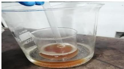
**Nota.** La figura representa el montaje de la reacción de transesterificación para la obtención del biodiésel.
