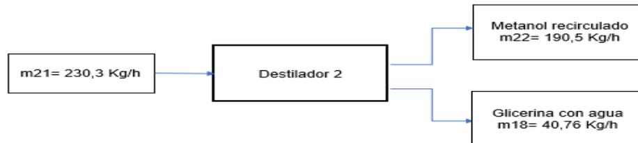
**Nota.** Esta figura muestra el balance de masa del destilador 2 de la purificación del biodiésel, para la simulación a  $P > 10$  bar
