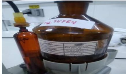
**Nota.** La figura representa la determinación del índice de acidez en la reacción de esterificación para la obtención de biodiésel, realizado en el laboratorio de la empresa C.I. SIGRA S.A.
