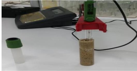
**Nota.** La figura representa la determinación del pH para el lodo residual.
