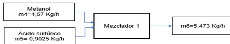
**Nota.** Esta figura muestra el balance de masa del mezclador 1 para la simulación a  $P > 10$  bar.
