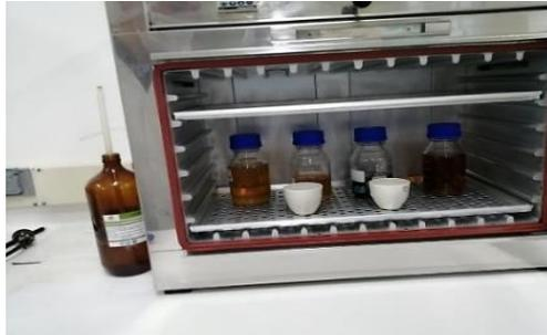
**Nota.** La figura representa las cenizas en el biodiésel, realizado en el laboratorio de la empresa C.I. SIGRA S.A.
