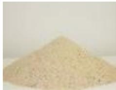
El granate es una alternativa ya que es un medio filtrante de densidad y dureza altas, le da capacidad de retener partículas de hasta 15 micrones, se muestra en la figura 67:
