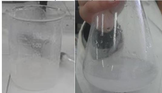
Después de 45 minutos no se observa más separación de impurezas en la muestra de 250 mL.
