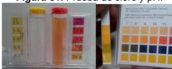
En la figura 83 se observa el resultado de la prueba realizada con el kit de piscina obteniendo que el nivel de cloro es 0,3 y el pH está entre 6,8 y 7,2, con las cintas de pH Merck, el pH da entre 6,8 y 6,9 de pH, el pH inicial es aproximadamente 6,8.
