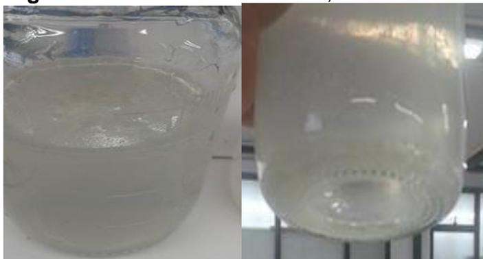
Con un volumen de 1,5 mL de rompedor de emulsiones se observa rompimiento de emulsión, se aprecia en la foto del lado izquierdo la cama con las impurezas flotando, se observa también que coalescieron, es decir que las partículas de la emulsión se unieron y flotaron, debido a que el rompedor de emulsiones tiene un efecto coagulante y floculante, se observa
