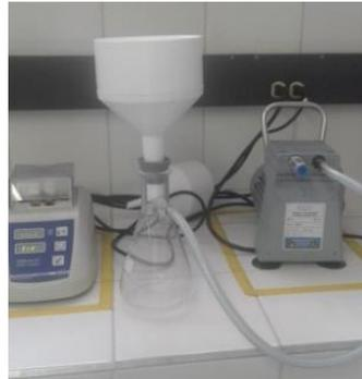
En este caso se utiliza una bomba al vacío para hacer más rápido el proceso de filtración.
