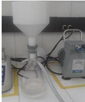
Debido a que el agua sigue siendo turbia, se recomienda tener un mejor uso del carbón activado y realizar el análisis a nivel industrial, en el primer experimento se presentó una menor turbiedad, se utilizó un filtro de embudo plástico con una mayor cantidad de carbón activado y un menor espacio
