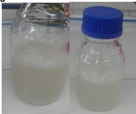
Con un volumen de 3 ml se observa una separación mayor a los volúmenes de las botellas anteriores, sin embargo no se observa sedimentación se partículas.
