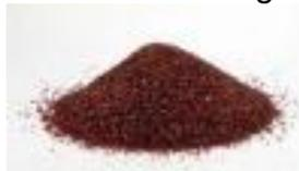
También se recomienda usar la cascarilla de arroz, su capacidad adsorbente es atribuida a la naturaleza de sus componentes, lignina, algunas proteínas, celulosa y hemicelulosa, permite la remoción de metales en solución hasta en un 80%, se muestra en la figura 68 a continuación:
