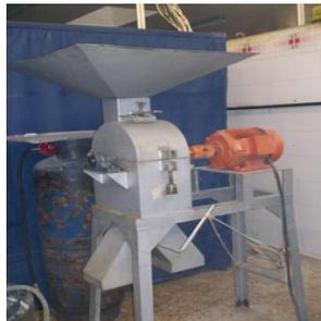
6. **Cutteado.** Se colocan las materias primas en el equipo, se agregan los condimentos y hielo y se entrega la pasta para mezclar o embutir. Los equipos utilizados en el proceso son descritos a continuación:
