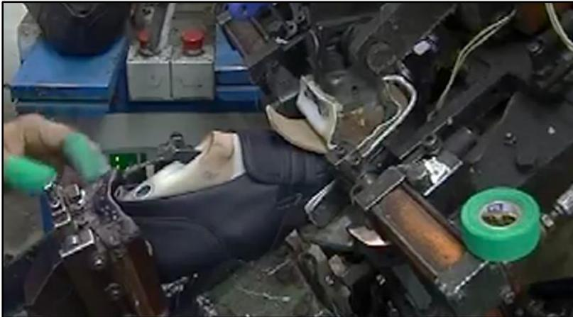
**Nota.** La figura muestra el montaje del calzado en la máquina montadora de puntas. Tomado de: cicegGTO. (2013, abril). video elaboración de calzado [Archivo de video]. recuperado de <https://www.youtube.com/watch?v=V25eP7kA3mk>
