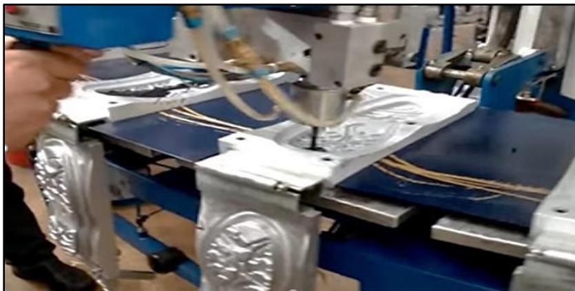
**Nota.** La figura muestra una inyección de plástico ABS para moldes de suela. Tomado de: usuario perdido <https://www.youtube.com/watch?v=jrByBZNbcEY>
