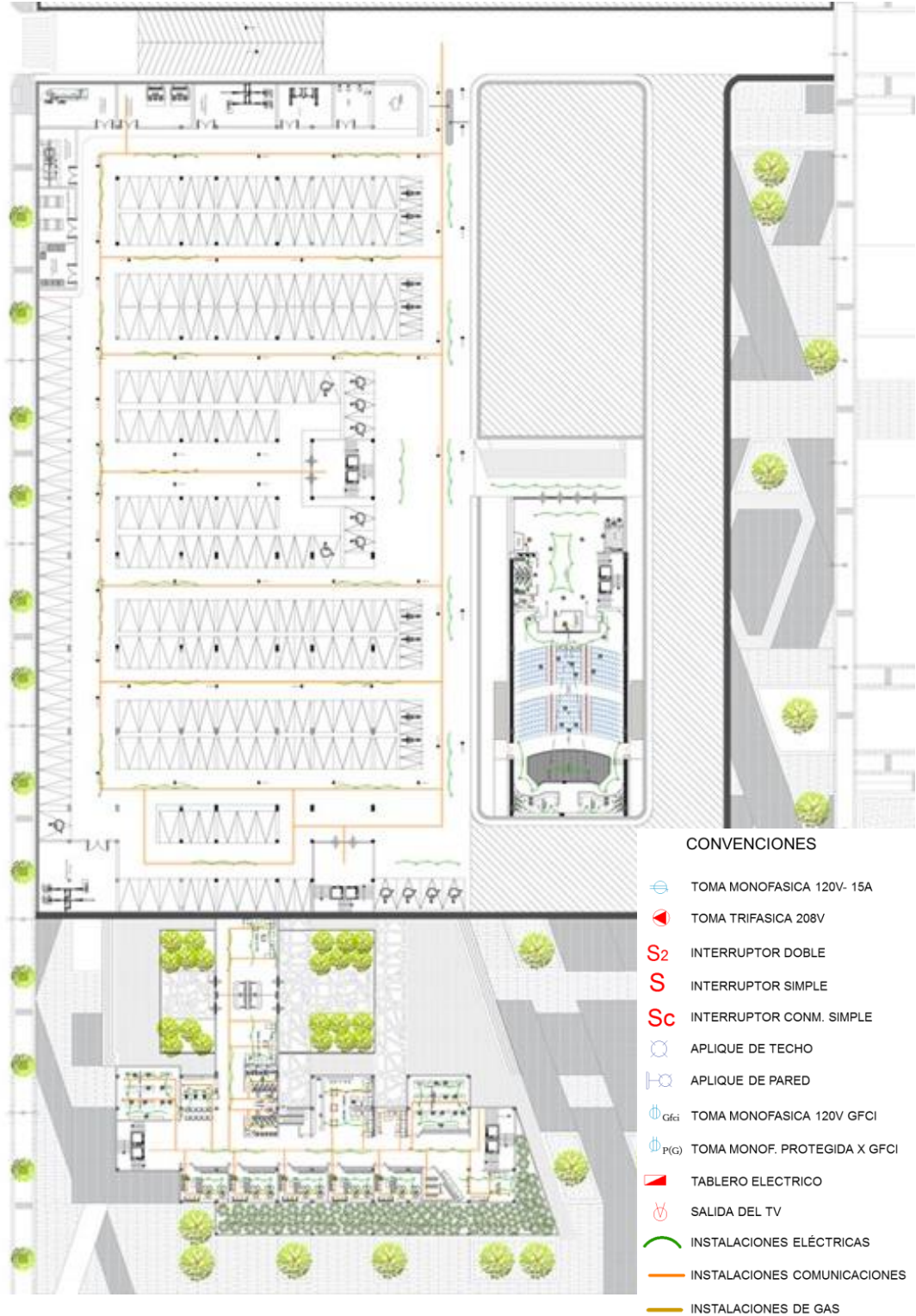
Plano 25. Planta eléctrica y comunicaciones sótano
