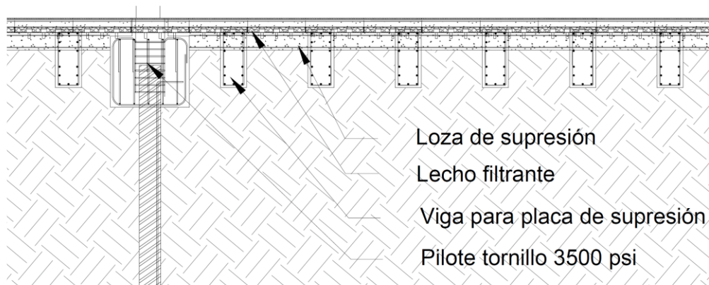
Imagen 65: Detalle placa de cimentación
