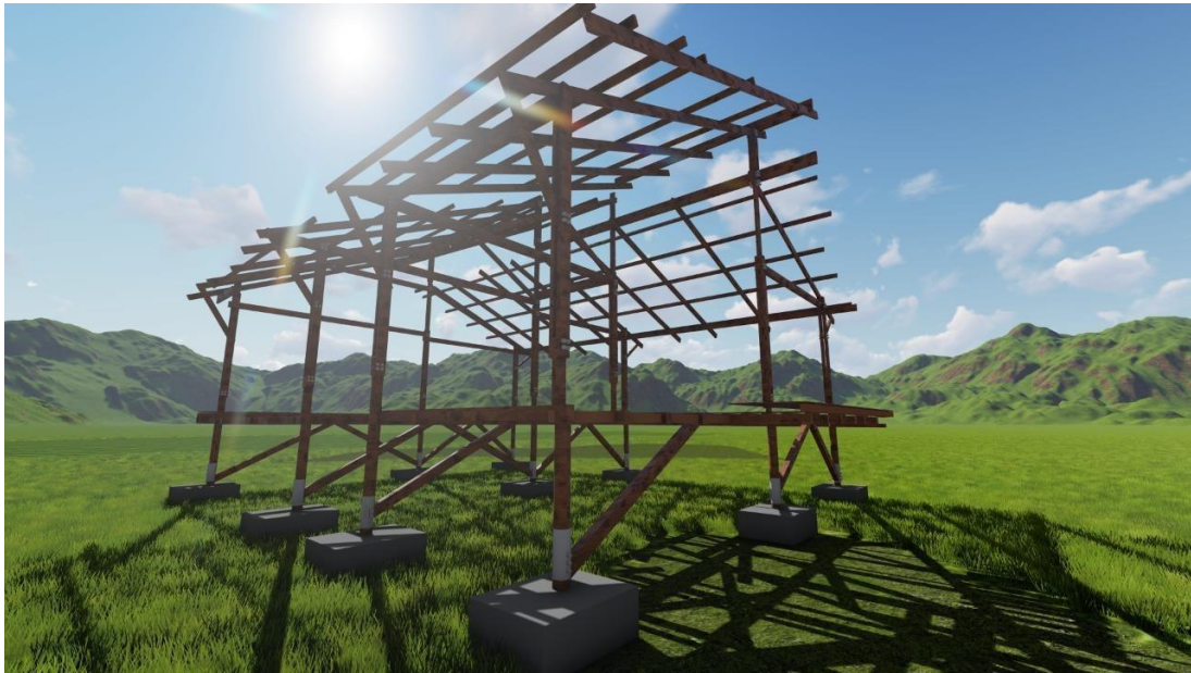
Sistema estructural 3D
