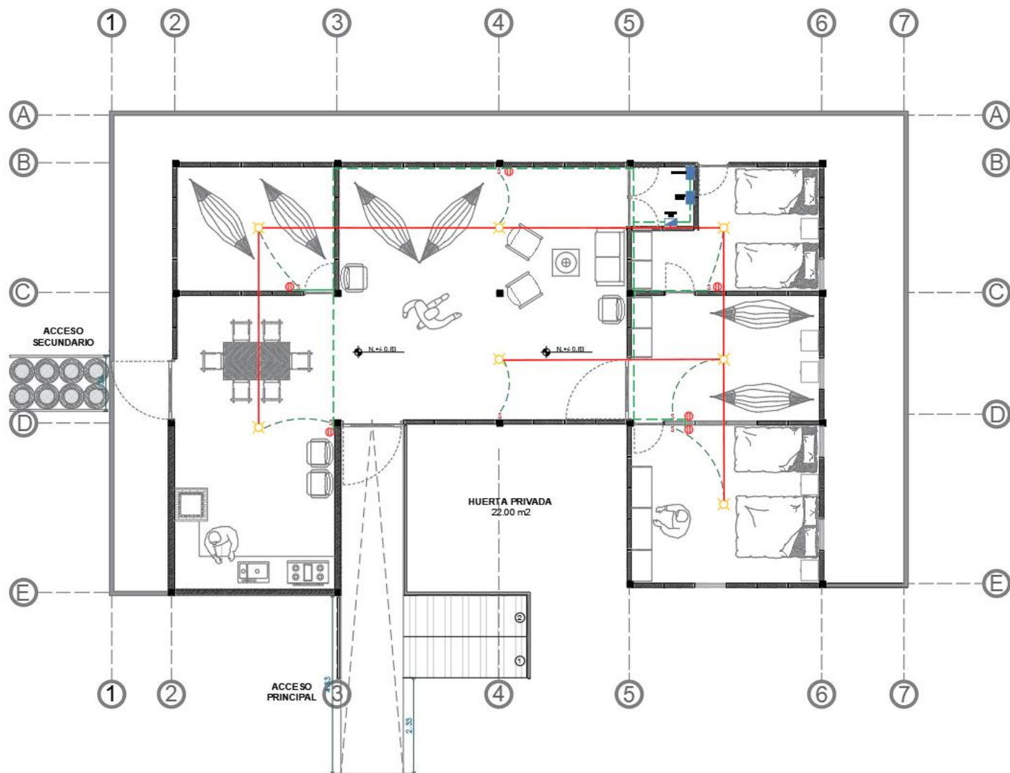
Figura 85. Red eléctrica vivienda.
