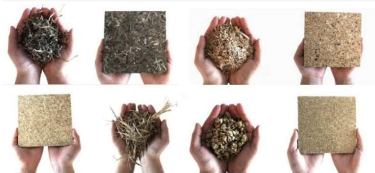
**Nota.** En la ilustración se marca como distintos materiales se pueden comprimir y generar texturas rígidas que tienen aplicaciones para distintos elementos como pisos o muros Tomado de: *Muñoz*, (10 de junio 2018) Un material orgánico que genera unas fachadas térmicas y maleable.
