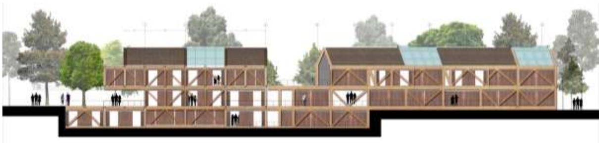
*Nota.* La fachada demuestra la extensión de los módulos y la repetición de la estructura.
