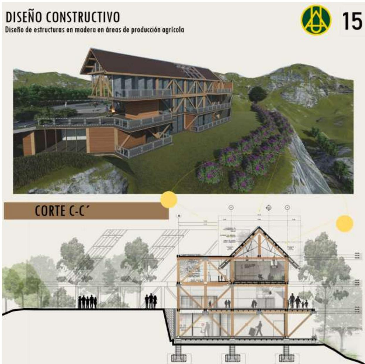
*Nota.* En la imagen se presenta una aproximación de la edificación y un corte que explica el sistema interno estructural y la cimentación según escala humana además de demarca los niveles de manera planimétrica y en tercera dimensión.
