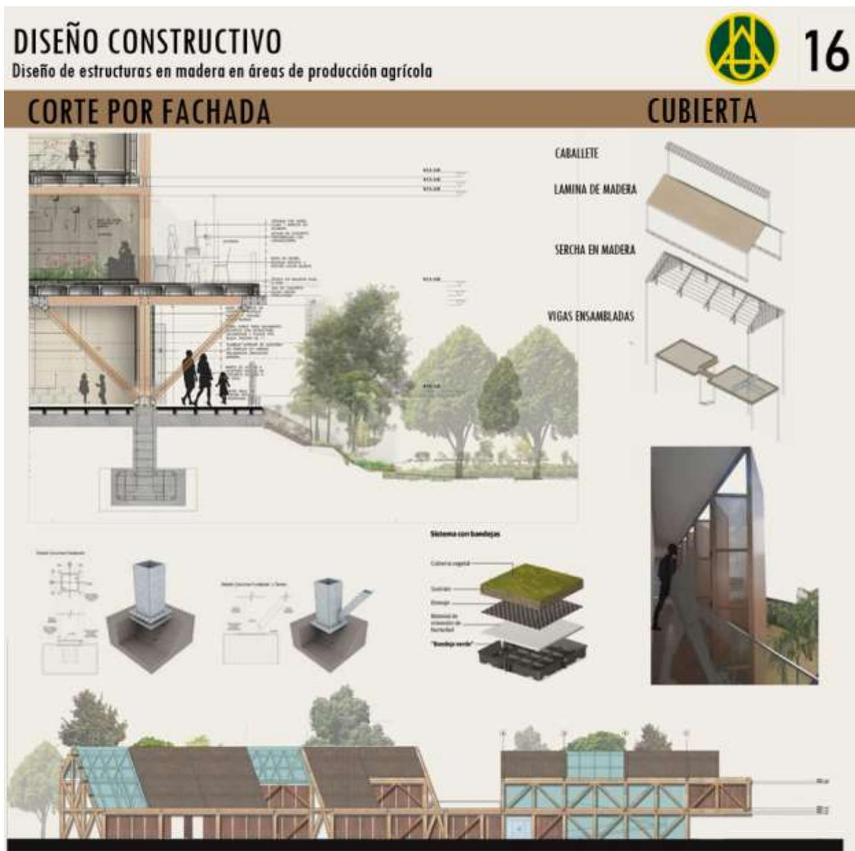
**Nota.** En la imagen se presenta un corte por borde de placa el sistema estructural de cubierta además de una aproximación del lugar y una vista en tercera dimensión de las cimentación y pilares estructurales y como se amarran a la estructura de madera.
