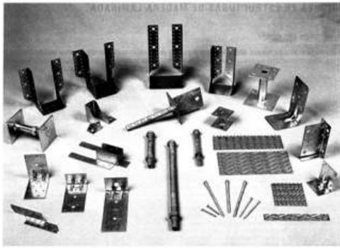
Los herrajes estándar permiten solucionar de forma económica y eficaz la mayoría de las uniones repetitivas que se producen en las estructuras de madera. El desarrollo de este tipo de herrajes es llevado a cabo por empresas especializadas, que realizan el diseño, someten a ensayos de resistencia a los herrajes y los fabrican en serie. En la mayoría de los casos, con el diseño de estos herrajes se intenta que un mismo elemento tenga multitud de aplicaciones, lo que los hace muy polivalentes.
