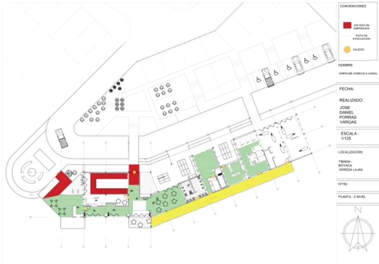
**Nota.** En la ilustración se muestra la planta de ruta de evacuación, las vías y salidas de evacuación. Según normativa
