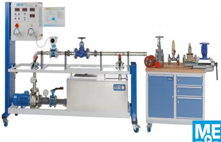
**Nota:** Banco de pruebas con posibilidad de intercambio de robinetería. Tomado de: Gunt Hamburg. (2021), “Banco de pruebas para robineterías y actuadores”, [En línea]. <https://n9.cl/92e8w> [08/25/2020]
