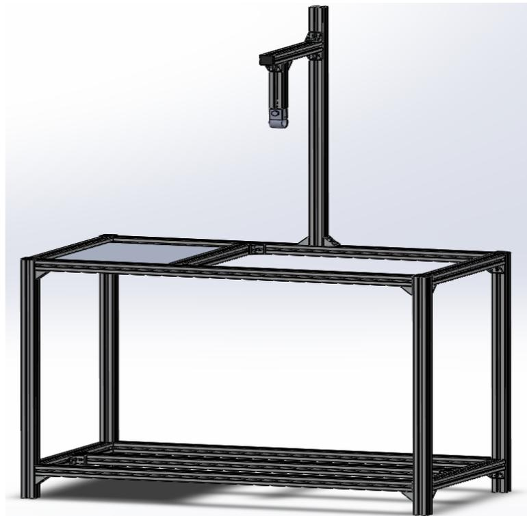
**Nota:** Esquema conceptual de la estructura del banco para pruebas, realizado en Solidworks versión estudiantil. Solidworks, Versión estudiantil. [En línea]. <https://www.solidworks.com/es/product/students>, Dassault Systèmes SolidWorks Corporation, Dassault Systèmes, 2020.
