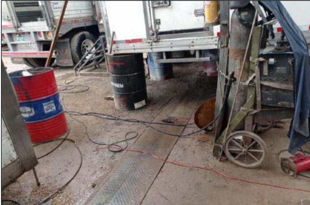
**Nota:** En la imagen se puede observar zonas inseguras causadas por falta de organización con los equipos utilizados en las intervenciones realizadas
