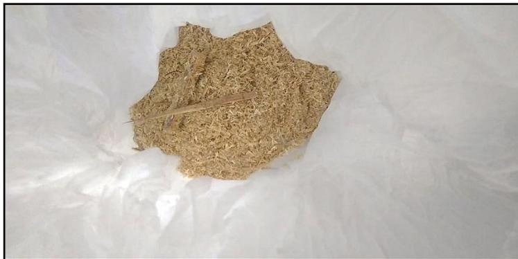
**Nota.** *Harina de madera utilizada en las probetas no puede ser residuos de aglomerado.*
