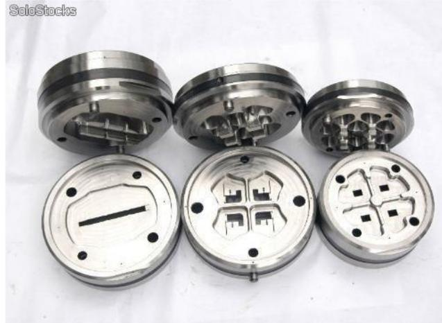
**Nota:** Se muestra las geometrías de los dados de extrusión de plástico. Disponible en. <https://www.solostocks.com.mx/venta-productos/aluminio/otros-productos-aluminio/fabricacion-de-dados-de-extrusion-2307023> [En Línea] visto el 23/11/2020.
