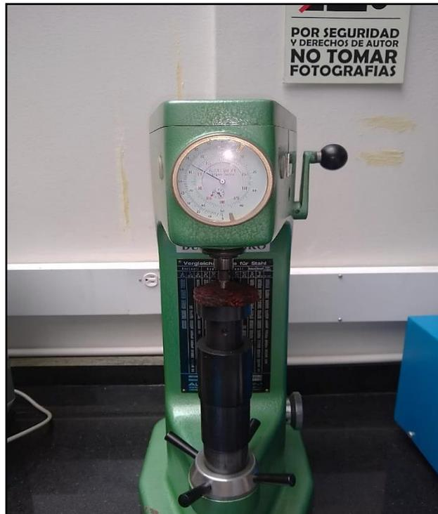
**Nota.** Se realizo una medición de dureza HR para la probeta %P/P.
