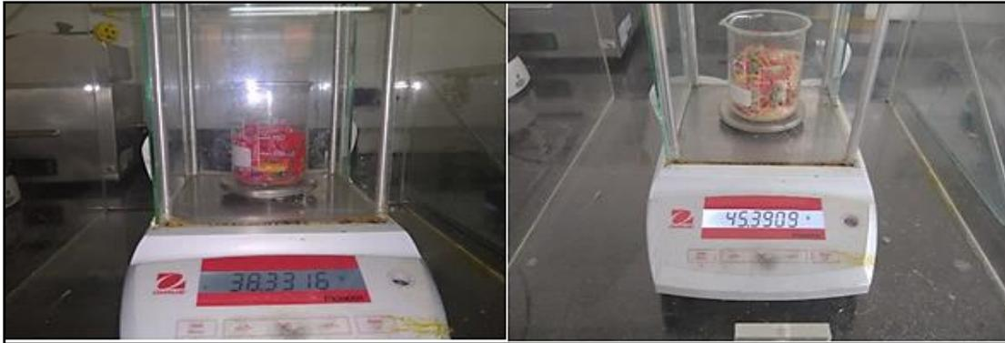
**Nota.** Se peso la metería prima en la proporción 75% PP y 25% harina de madera para una probeta de 40mL
