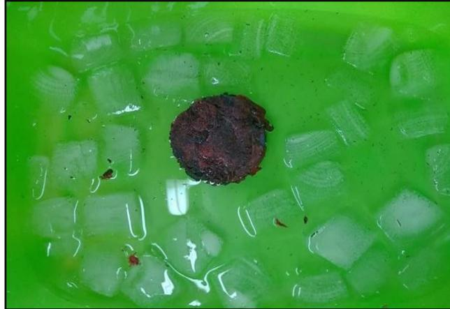
**Nota.** El enfriamiento de las probetas se realiza en agua con hielo a 4°C.
