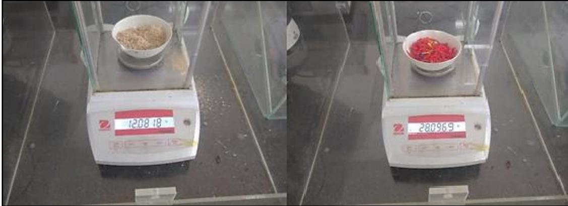
**Nota.** Se peso la metería prima en la proporción 75% PP y 25% harina de madera para una probeta de 40gr.
