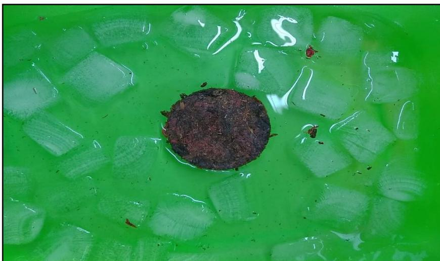
**Nota.** El enfriamiento de las probetas se realiza en agua con hielo a 4°C.
