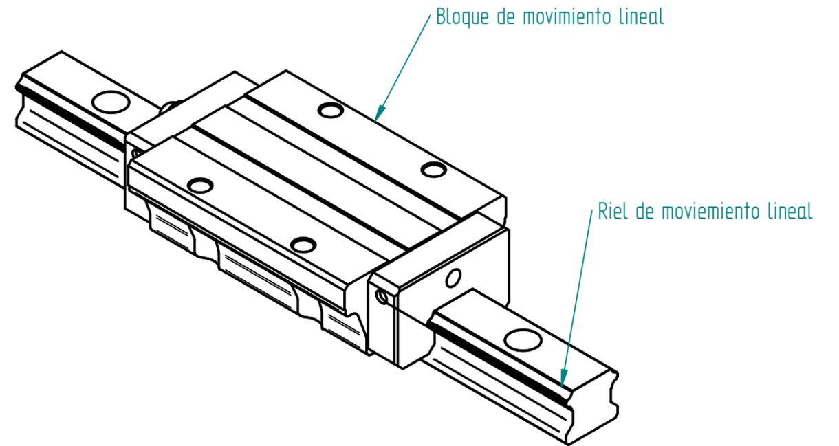
El riel de movimiento puede variar su longitud según se requiera el desplazamiento y cuenta con agujeros de 6 mm para su anclaje o unión con soldadura 7018
