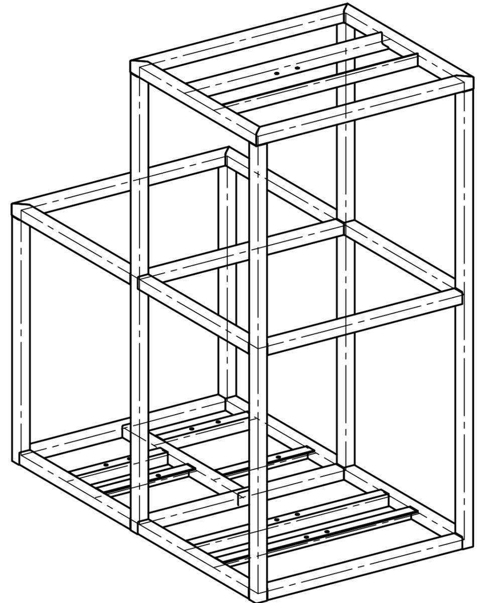
Toda la estructura se encuentra elaborada en perfil tubular de 1"- $\frac{1}{2}$  de 2 mm de espesor a excepción de los soportes de fijación que están elaborados en ángulo estructural de 1"- $\frac{1}{2}$  de 3 mm de espesor.
