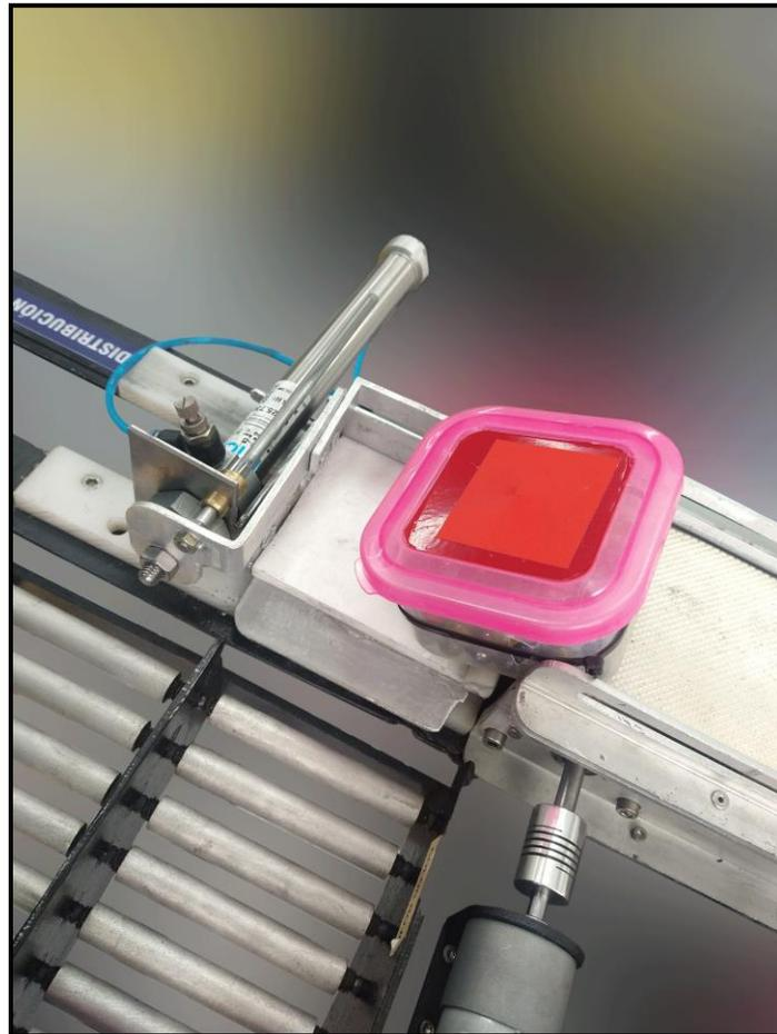
**Nota.** En la figura se puede observar la posición que presenta el recipiente antes de ingresar al carro clasificador, siendo obstaculizado por la rampa de entrada y una de las paredes del carro clasificador.
