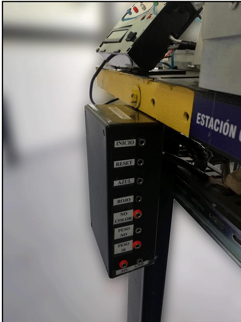
**Nota.** En la figura se muestran los bornes colocados en la cada dónde se encuentra la tarjeta de potencia diseñada en el módulo de control de calidad.
