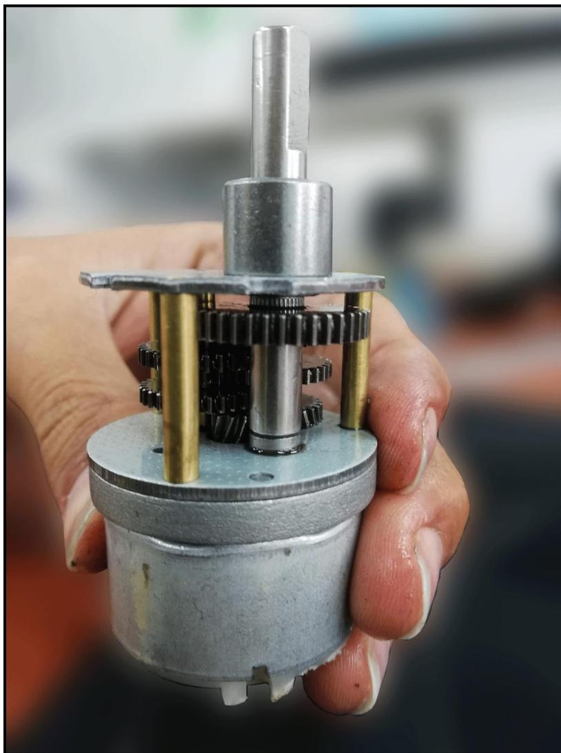
**Nota.** En la figura se puede observar el estado de los engranajes de la caja reductora del motor 1.
