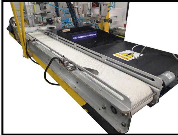
Este módulo se compone principalmente de 2 bandas transportadoras con estructura en aluminio y banda tipo waffer blanca de 90mm de ancho, estas bandas están acopladas cada una a un motor de 24V DC capaz de entregar 80RPM, esta velocidad puede ser regulada mediante un controlador PWM para cada banda. La banda transportadora #1 cuenta con una longitud de 55cm mientras que la banda transportadora #2 cuenta con una longitud de 76cm.
