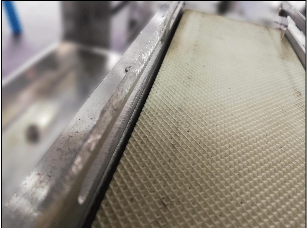
**Nota.** En la imagen se puede apreciar la manera en que se rebajó la gualdera que impedía el funcionamiento adecuado de diferentes módulos.
