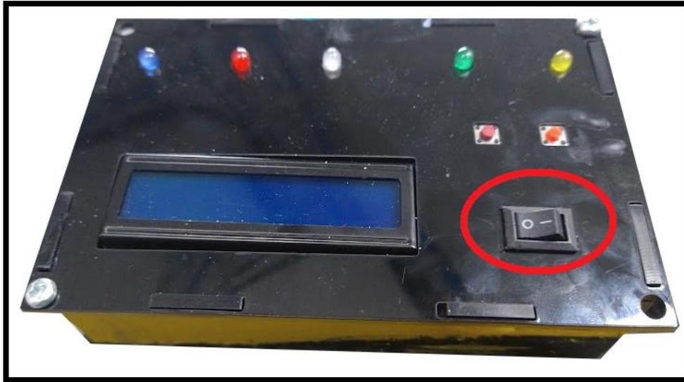
6. Una vez la pantalla LCD presente en la interfaz física del sistema de control de calidad muestre el mensaje “esperando”, energice los componentes eléctricos girando la muletilla a la posición ON.
