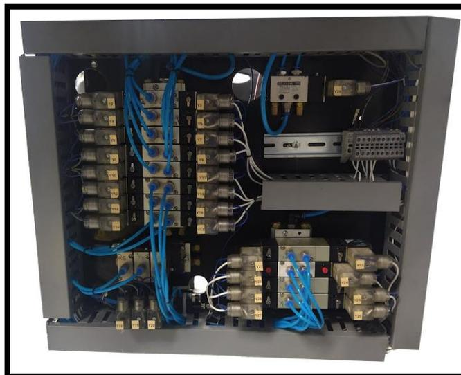
En este tablero se encuentran alojadas todas la válvulas que manipulan a los diferentes actuadores, entre sus componentes se encuentran: 9 válvulas 5/2 biestables, 3 válvulas 5/3 monoestables, 3 válvulas 3/2 monoestables, 1 válvula 5/3 monoestable, 1 válvula reguladora de presión y 2 toberas de succión de vacío.
