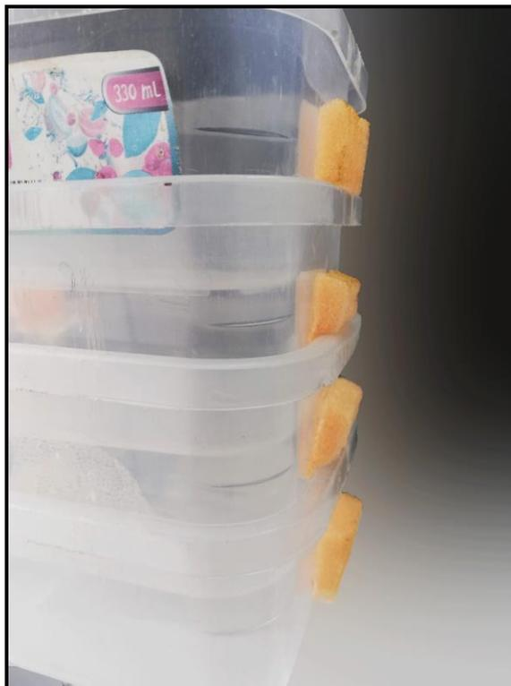
**Nota.** En la figura se muestra el comportamiento de la espuma al momento de apilar los envases.
