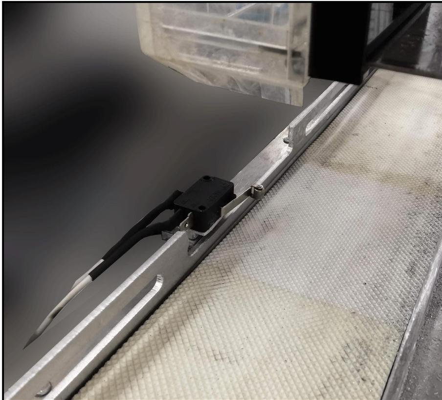
**Nota.** En la figura se observa el corte realizado en la gualdera de la banda transportadora 1 y la posición del final de carrera 1.
