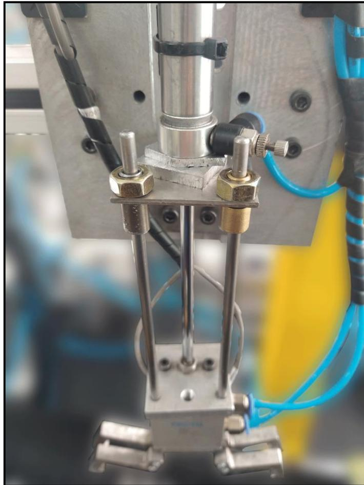
**Nota.** En la figura pueden ser apreciadas las platinas realizadas en el taller de máquinas y herramientas de la Universidad de América.
