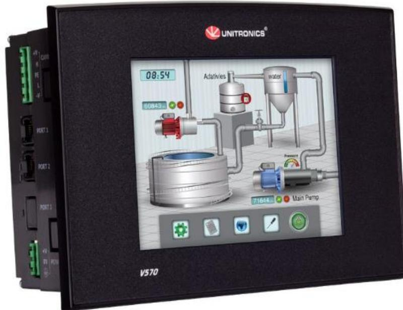
El PLC Unitronics Vision570 cuenta con una pantalla táctil de 5,7" de alta resolución para el diseño del HMI, así mismo, en este caso se hace uso de un módulo E/S integrado V200-18-E62B el cual cuenta con 30 entradas y 30 salidas digitales.
