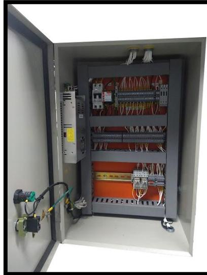
En este tablero se encuentran todos los componentes necesarios para energizar todo el equipo, así como permitir el correcto flujo de corriente eléctrica entre los actuadores, sensores y el PLC. En la parte exterior del contenedor se encuentra ubicada la muletilla que permite encender y apagar el equipo en el momento en que el usuario así lo requiera.
