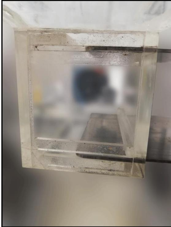
**Nota.** La figura muestra los rieles de la cámara de predosificado limpios, con las compuertas dentro de ellos
