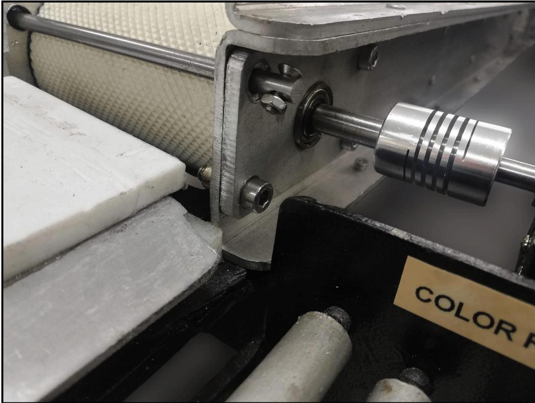
**Nota.** En la figura se observa el rodillo fabricado con retales del taller de máquinas y herramientas de la Universidad de América. Tiene 4 milímetros de diámetro y es incorporado en la banda transportadora 2.
