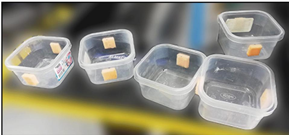
**Nota.** En la figura se muestra la disposición en que fue adherida la espuma a los recipientes.
