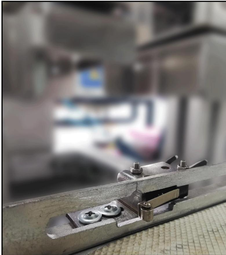
**Nota.** La figura muestra el rebaje de las gualderas acompañado del montaje del final de carrera 2
