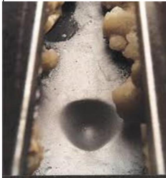
**Nota.** La figura muestra la formación de escamas inorgánicas en tuberías de producción tras el paso de la lechada abrasiva. Tomado de: Schlumberger, “La lucha contra las incrustaciones-remoción y prevención”, [En línea]. Disponible: <https://www.slb.com/-/media/files/oilfield-review/p30-49> [Acceso: feb.22,2021]
