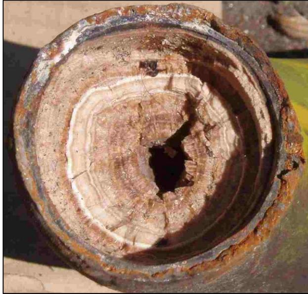
**Nota.** La figura detalla el daño provocado en una tubería de producción tras ocurrir la precipitación de la incrustación inorgánica. Tomado de: Merus, “Protección contra las calcificaciones en tuberías y máquinas”, [En línea]. Disponible: [https://www.merus.es/proteccion\\_calcificaciones/](https://www.merus.es/proteccion_calcificaciones/) [Acceso: feb.22,2021]
