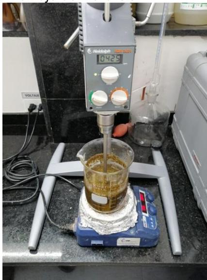
**Nota.** La figura presenta el montaje correspondiente a la preparación de la mezcla para la obtención de mucilago, a temperatura y agitación constante.
