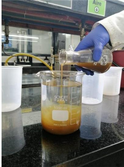
**Nota.** La figura expone el proceso de mezcla entre el material filtrado y el alcohol absoluto para promover la precipitación del mucilago.
