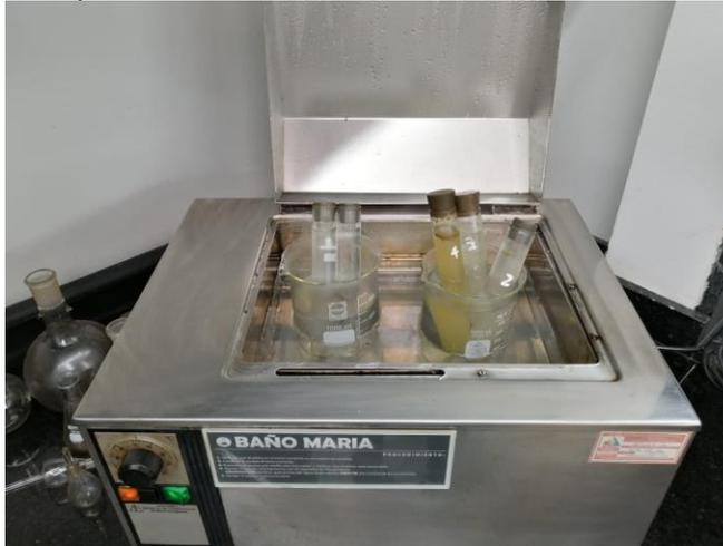
**Nota.** La figura detalla el montaje para la evaluación del producto bajo parámetros estipulados en la norma NACE TM 0374 del año 2007.
