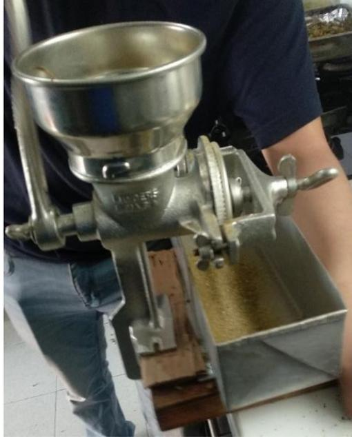
**Nota.** La figura puntualiza el proceso de trituración de la planta seca para la obtención del polvo de materia prima fino.
