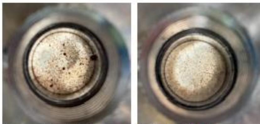
Figura 2: Pastillas KBr con muestra (der.) y duplicado (izq.)
