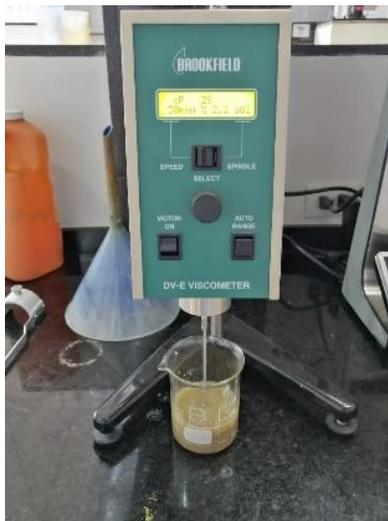
**Nota.** La figura detalla la determinación de la viscosidad del producto acuoso mediante la aplicación del equipo Brookfield.
