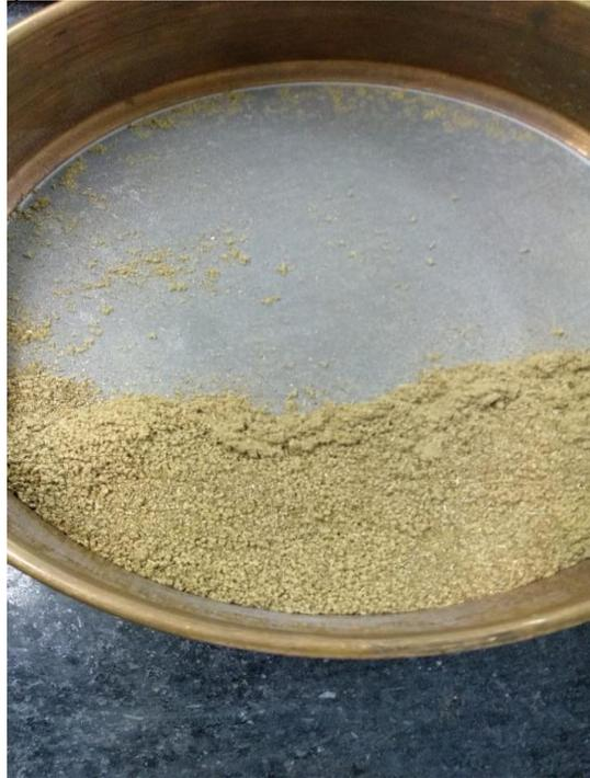
**Nota.** La figura detalla el material más fino con respecto a la materia prima luego de pasarla por un proceso de tamizado mediante el uso de mallas de diámetro muy pequeño.
