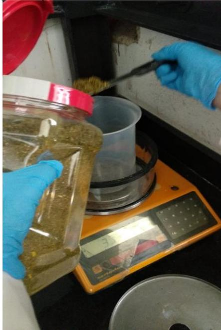
**Nota.** La figura muestra el proceso de peso de materia prima para la preparación de muestras con el fin de obtener el mucilago.
