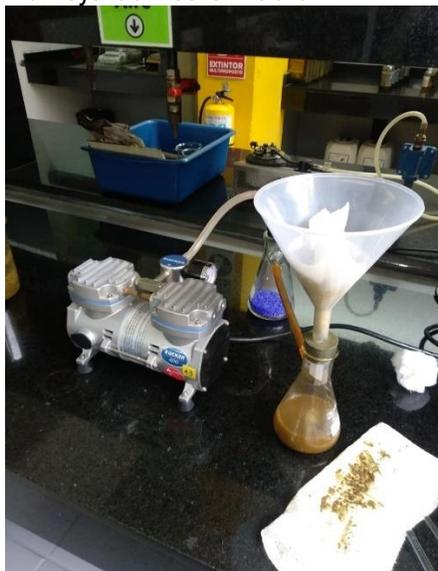
**Nota.** La figura muestra el proceso para la obtención del material filtrado de mucilago.
