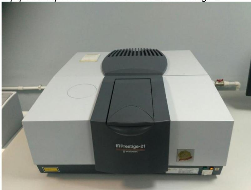
**Nota.** La figura muestra un ejemplo del equipo usado para la medición y caracterización de los grupos funcionales mediante espectrofotometría IR. Tomado de: Saint Petersburg State University, "FTIR spectrometer IRPrestige-21", [En línea]. Disponible: <https://laser.spbu.ru/en/equipment-eng/irprestige-eng.html> [Acceso: abr.10,2021]
