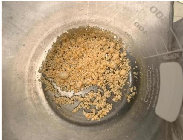
**Nota.** Representación del proceso de impregnación del óxido de cobre hexahidrato sobre las nanopartículas soporte.
