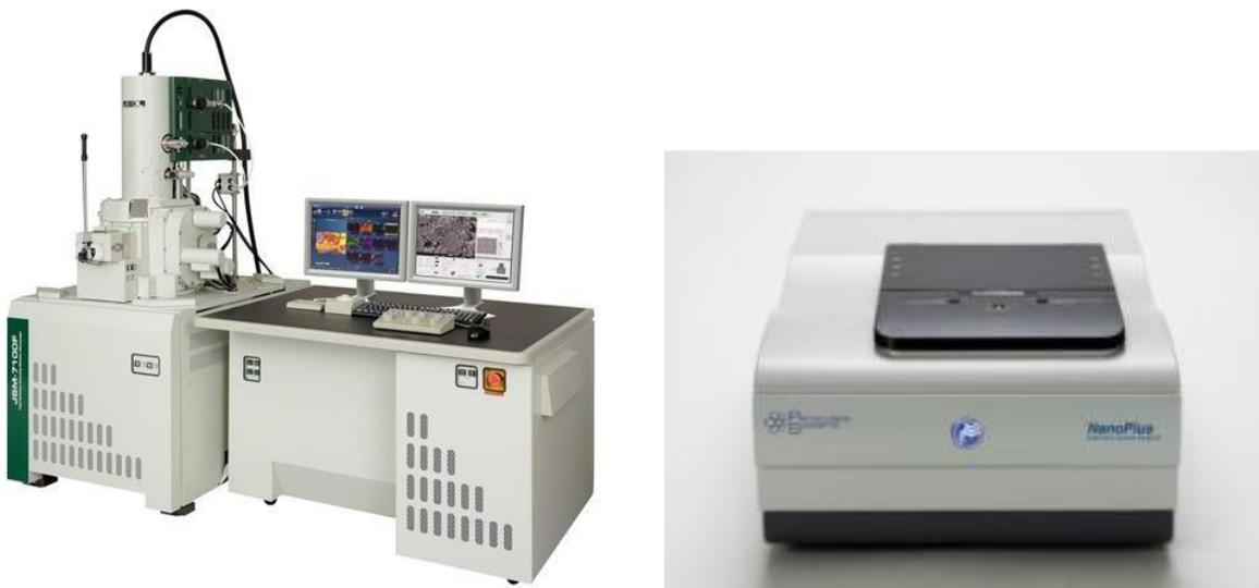
**Nota.** Elementos usados para definir el diámetro hidrodinámico de las nanopartículas SiO<sub>2</sub> - Janus.
