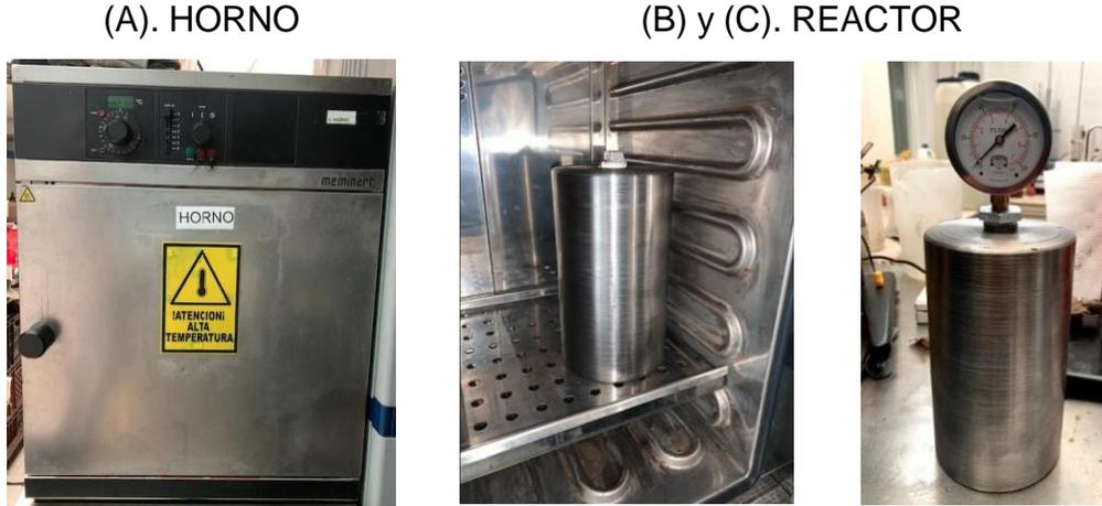
**Nota.** Dispositivos usados para el procedimiento de reducción de viscosidad durante la inyección cíclica de vapor.
