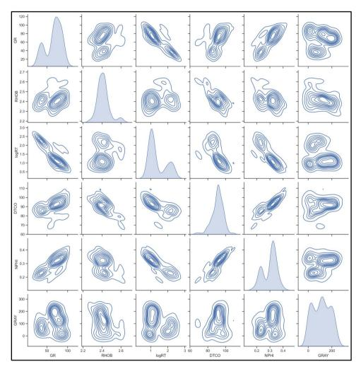
**Nota.** La figura representa el diagrama de parejas de variables. La diagonal muestra los histogramas de cada variable y cada gráfica no diagonal muestra un *crossplot* entre variables con líneas de contorno para indicar la concentración de los datos. El componente principal de la gráfica es la última fila, que muestra la relación entre la variable Gray (objetivo) y todos los registros de pozo (*features*).
