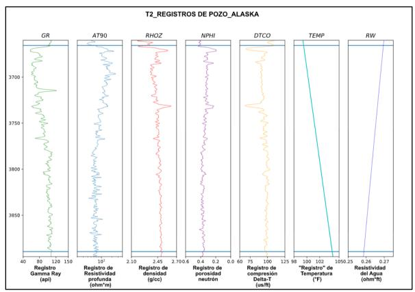
*Nota.* La figura muestra siete *tracks* del pozo representativo T2. De izquierda a derecha, está el registro GR (línea verde), registro AT90 (línea azul), registro RHOZ (línea roja), registro NPHI (línea morada), registro DTCO (línea amarilla). Seguidos se encuentran el "registro de temperatura" (línea cyan) y por último los valores calculados a modo de registro de la resistividad del agua (línea azul oscura) (sección 2.4.3).
