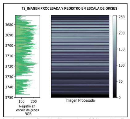
*Nota.* La figura muestra la representación gráfica del procesamiento de imágenes UV y el registro en escala de grises del pozo T2. A la derecha de la figura, está el procesamiento final del conjunto de imágenes UV en una escala de grises entre 0 y 255. A la izquierda de la figura, está el registro en escala de grises-RGB que toma en el eje x los valores del rango de las imágenes y en el eje y las profundidades para cada valor.
