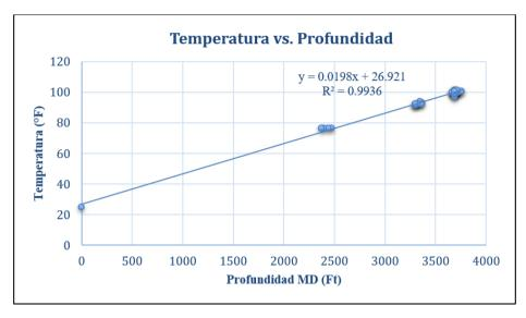
*Nota*. La figura muestra la gráfica de temperatura en grados Fahrenheit en función de la profundidad MD en pies (ft) con regresión lineal del pozo representativo (T2).
