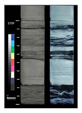
Nota. La figura enmarca dos tipos de imagen en una muestra de roca a 3709 ft aproximadamente del pozo T2. Al lado izquierdo se encuentra la imagen capturada bajo luz blanca y al lado derecho a la misma profundidad, la imagen capturada bajo luz UV. Se muestra la diferencia de los espectros de luz incidentes sobre la muestra. Tomada de: Weatherford Laboratories- Imágenes extraídas de las carpetas de pozo encontradas de la información pública.
