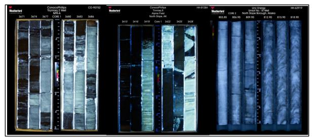
*Nota.* La figura muestra tres fotografías digitalizadas de corazones tomadas bajo luz ultravioleta (representativas del conjunto de fotos UV) de los pozos T2, T6 y U18 en formato de cajas a diferentes profundidades.
