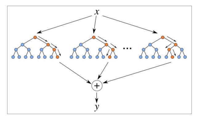
Nota. La figura muestra la estructura del modelo de Random Forest durante su periodo de ejecución. La X en la figura representa el conjunto de datos de entrada para que sean procesados. El símbolo (+) representado en la figura, es la acumulación de todas las predicciones ejecutadas. Mientras que (Y) es la predicción final del modelo. Tomado de: Gitconnected [En línea]. Disponible: https://levelup.gitconnected.com/random-forest-regression-209c0f354c84
