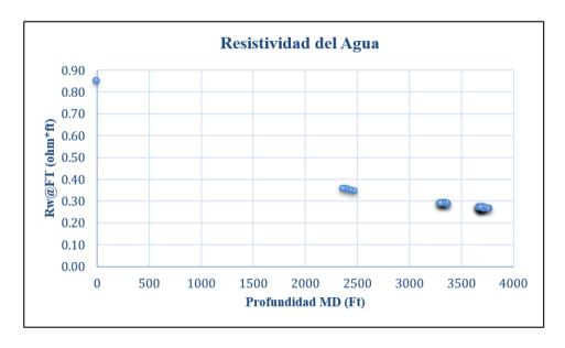
*Nota.* La figura muestra la gráfica de resistividad del agua (ohm-ft) en función de la profundidad MD (ft) del pozo representativo T2. En la gráfica se visualiza el comportamiento descendente de la resistividad a medida que aumenta la profundidad.
