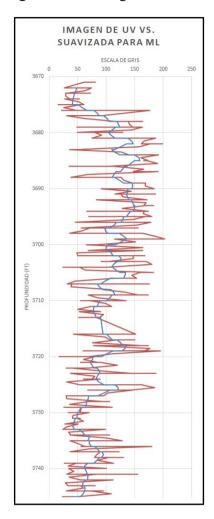
**Nota.** La figura representa la previsualización de los datos del registro en escala de grises sin preprocesamiento por profundidad (línea roja) y los valores obtenidos del preprocesamiento (suavizado) del registro de grises por profundidad (línea azul).
