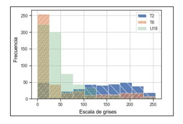
*Nota.* La figura representa el histograma de la variación de la escala de grises en función de la frecuencia absoluta de los datos para los pozos T2 (azul oscuro), T6 (naranja) y U18 (verde) Elaboración propia.
