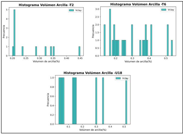
**Nota.** La figura muestra las gráficas del Histograma del volumen total de arcillas (*Vclay*) en porcentaje en función, de la frecuencia de los datos obtenidos del laboratorio. Las barras de color cian en cada histograma, representa la frecuencia de los valores representados para cada uno de los pozos.
