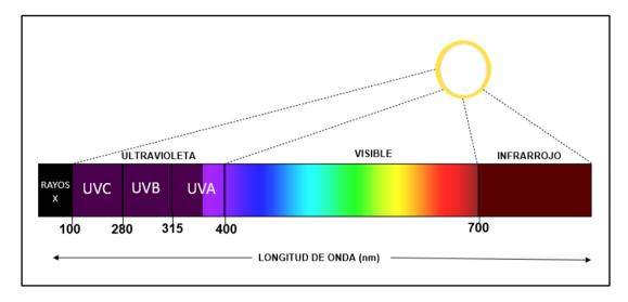
*Nota.* La figura representa la escala cromática de los espectros de Luz. Se muestran 4 secciones y los rangos de longitud de onda (nanómetros) en la que se encuentra cada espectro. De la sección de luz ultravioleta: UVC es la banda de luz corta de 100-280 nm, UVB banda de luz de onda media de 280-315 nm y UVA banda de luz larga de 315-400 nm.
