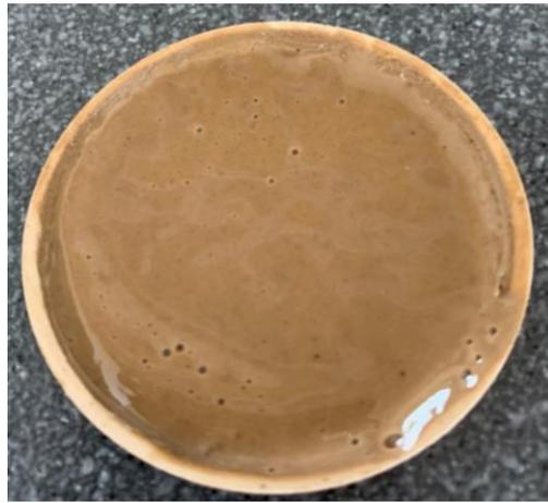
**Nota.** Las anteriores fotos muestran la torta de revoque formada en las pruebas de filtrado HPHT y PPT con la incorporación de los nanomateriales en la formulación escogida inicialmente.
