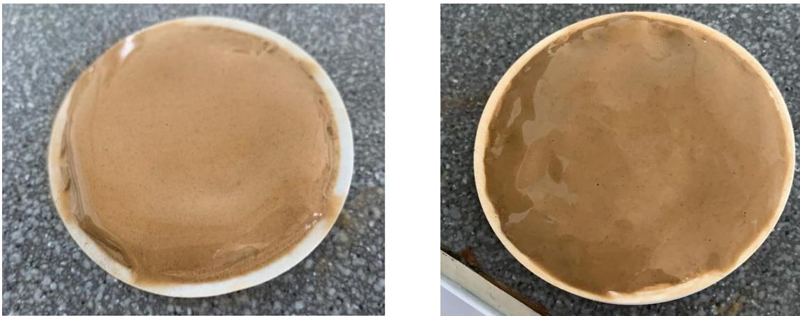
**Nota.** Las anteriores fotos muestran la torta de revoque formada en las pruebas de filtrado HPHT y PPT únicamente con la formulación escogida inicialmente.
