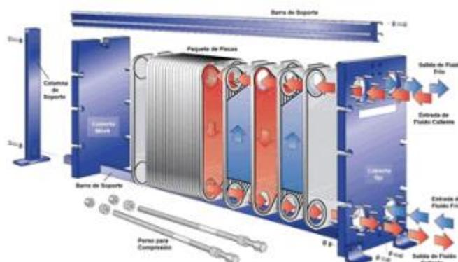
**Nota.** En la figura se representa un intercambiador de placas, con la representación del flujo de los fluidos, manejando un flujo cruzado. Tomado de: E. Torres Tamayo, Y. Retirado Medianeja, y E. Góngora Leyva, "Coeficientes de transferencia de calor experimental para el enfriamiento de licor en intercambiadores de placas," *Ing. Mecánica*, vol. 17, no. 1, pp. 68–77, 2014
