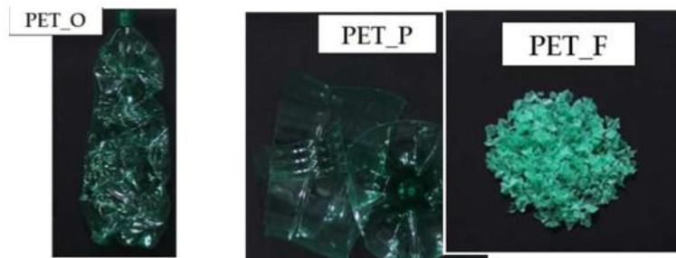
*Nota.* Esta imagen muestra como el plástico llega a la planta y como se convierte después de realizar el acondicionamiento. Tomado de M: “Moroni and A. Mei, “Characterization and separation of traditional and bio-plastics by hyperspectral devices,” *Appl. Sci.*, vol. 10, no. 8, 2020, doi: 10.3390/APP10082800.
